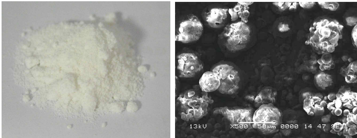
(그림 6.9) MPCM의 형태와 SEM 분석 결과
