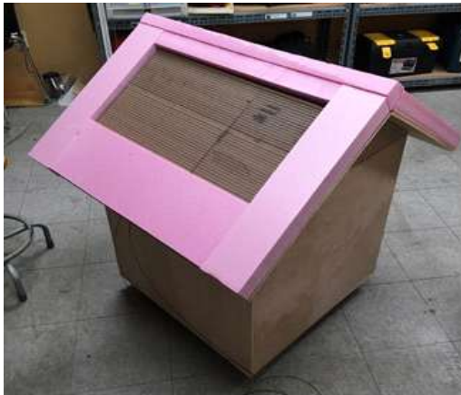
(그림 3.105) 박공(경사)지붕 제작 및 온도측정지점
