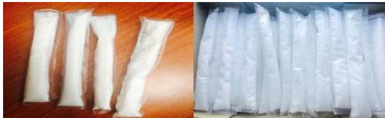
(그림 3.77) Packing type PCM 제작
