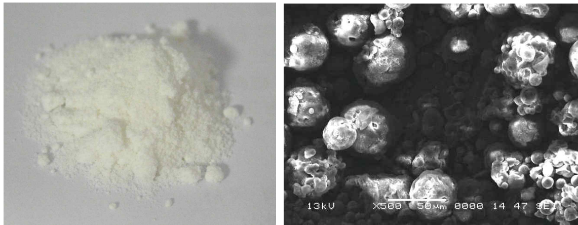
(그림 3.11) MPCM의 형태와 SEM 분석 결과
