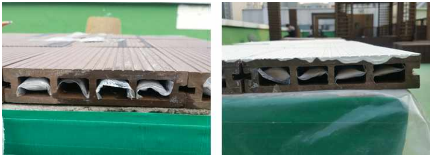
(그림 3.84) PCM Cool Roof System의 제작
