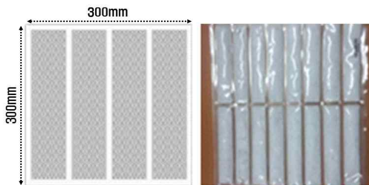
(그림 3.67) Packing type PCM 제작
