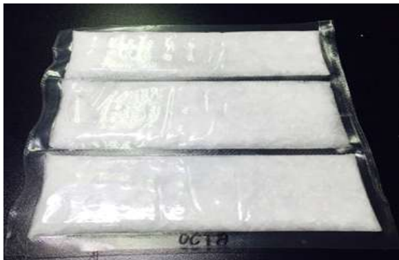
(그림 3.117) n-octadecane이 적용된 MPPCM (총 180g)
