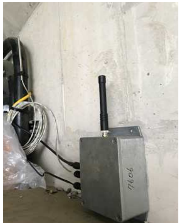
<그림 3.65> RTD 온도계 및 신축변위계 연결
