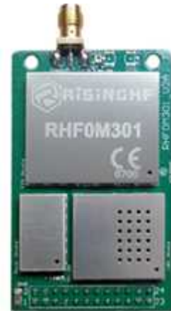
<그림 3.8> LoRa 게이트웨이(G/W) 시작품 제작사진
