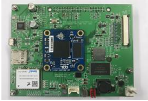
<그림 3.12> LoRa 스마트센서노드(DAQ) 시작품 제작 및 성능 제원
