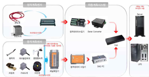
<그림 2.2> 암사대교 모니터링 시스템 전달방식
