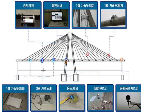
<그림 2.14> RFID USN 올림픽대교 Test Bed 현장적용
