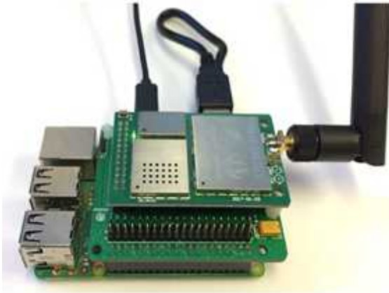
<그림 3.8> LoRa 게이트웨이(G/W) 시작품 제작사진
