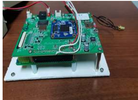
<그림 3.14> 멀티센서보드 / 스마트센서노드 인터페이스
