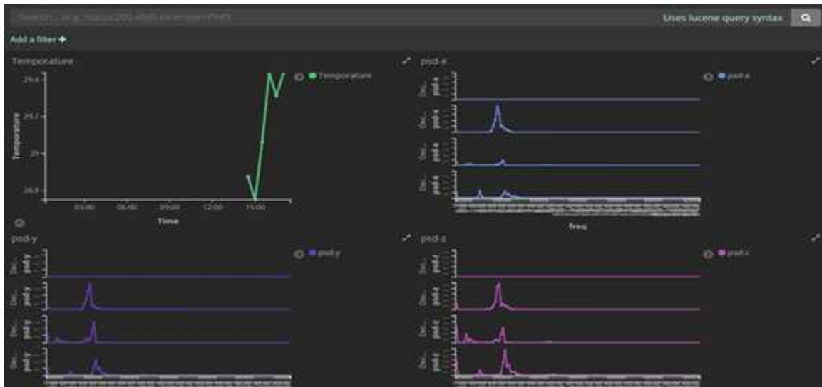
<그림 3.11> LoRa LPWAN 기반 무선 계측 화면 (가속도계 통한 PSD : Power Spectral Density)
