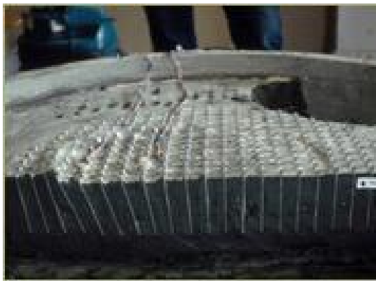
그림 14-(a). 원심모형실험을 이용한 Rion-Antirion Bridge 기초 내진 설계
