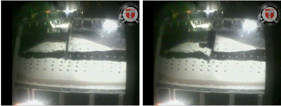
그림 13. New Orleans 제방 붕괴 모사 시험
