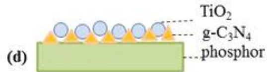
Fig. 3.3.1 코팅 프로세스 흐름도 (a) TiO 2 (b) g-C 3 N 4 와 형광체 지지체에 하이브리드 광촉매 코팅 (c) g-C 3 N 4 와 (d) TiO 2 의 셀 코팅.
