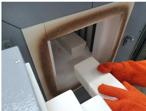
Fig.2.3.1 축광체 1 batch 제조용 전기로 장치
