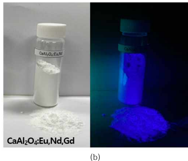
Fig. 2.2.1 (a) \text{CaAl}_2\text{O}_4 의 합성을 위한 고상반응법 순서도, (b) Gd-doped \text{CaAl}_2\text{O}_4:\text{Eu}^{2+},\text{Nd}^{3+} 분말의 밝고 어두운 조건에서의 이미지.
