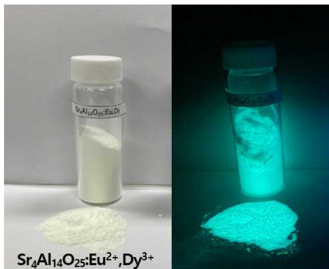
Fig. 2.1.1 합성된 \text{Sr}_4\text{Al}_{14}\text{O}_{25}:\text{Eu}^{2+},\text{Dy}^{3+} 축광체 분말 사진
