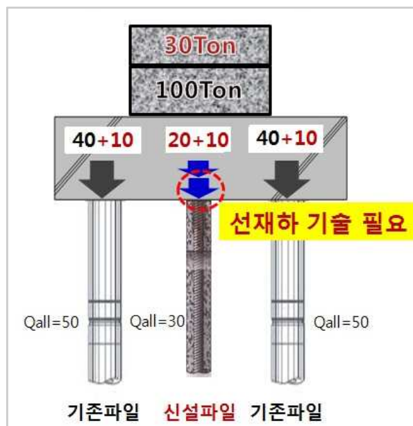
그림 1.18 선재하 파일 시공방법(한국건설기술연구원, 2014)
