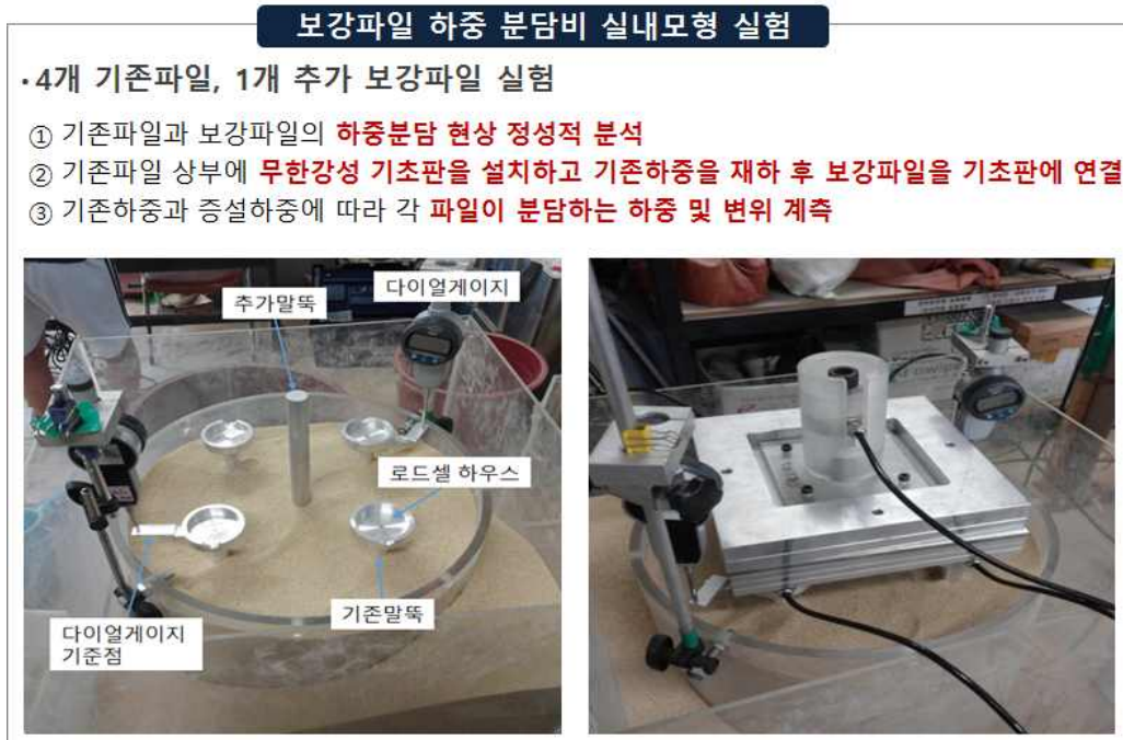
그림 1.16 신설 말뚝 하중분담비 실내모형실험(한국건설기술연구원, 2014)
