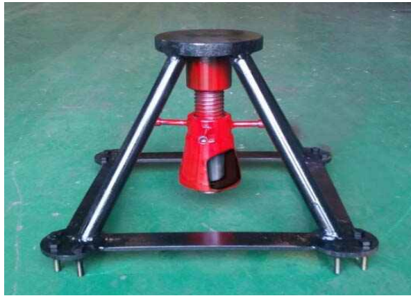
그림 1.6 1차 개발된 선재하 장치(피라미드형 선재하 장치)
