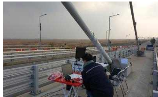
(d) D Bridge Cable Tension Measurement
