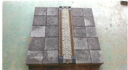
<집수로 설치 투수블록>
