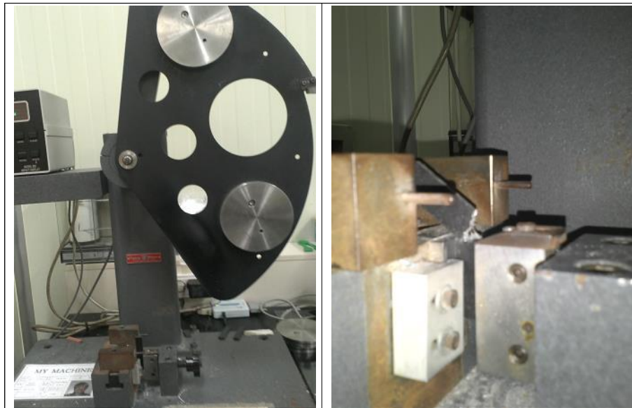
<그림3.1.15> 아이쥔드 시험장치 및 파격 후 시험편 장면
