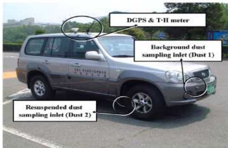
그림 2-6. 실시간 silt loading 측정을 위한 이동먼지측정시스템(국립환경과학원(2010))
