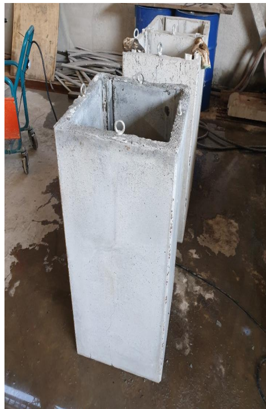
[그림 2.106] TRC 영구거푸집 제작용 강재 거푸집 설계 도면 및 시제품
