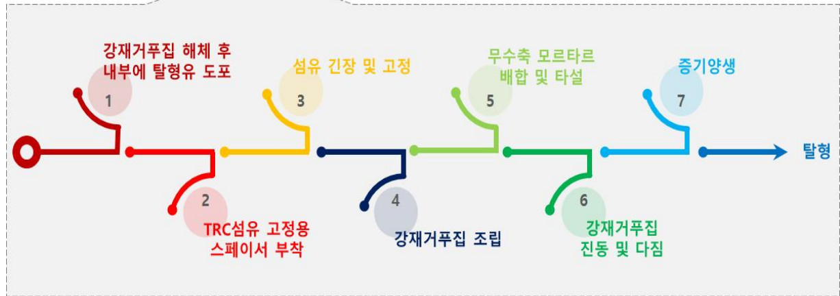
[그림 2.105] TRC PC 영구거푸집 제작 공정 최적화 방법 개발
