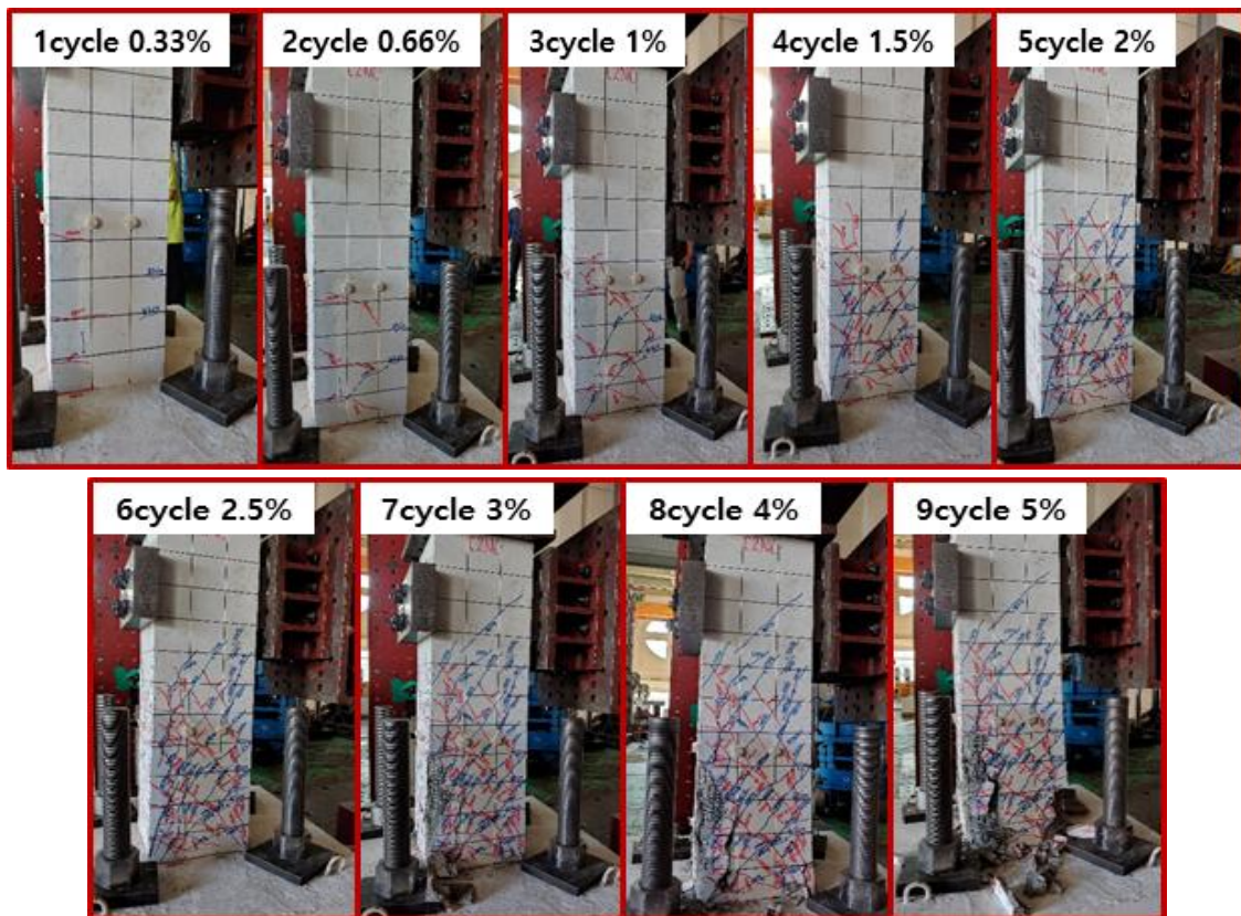
[그림 2.19] C2NC실험체의 균열 및 파괴 양상
