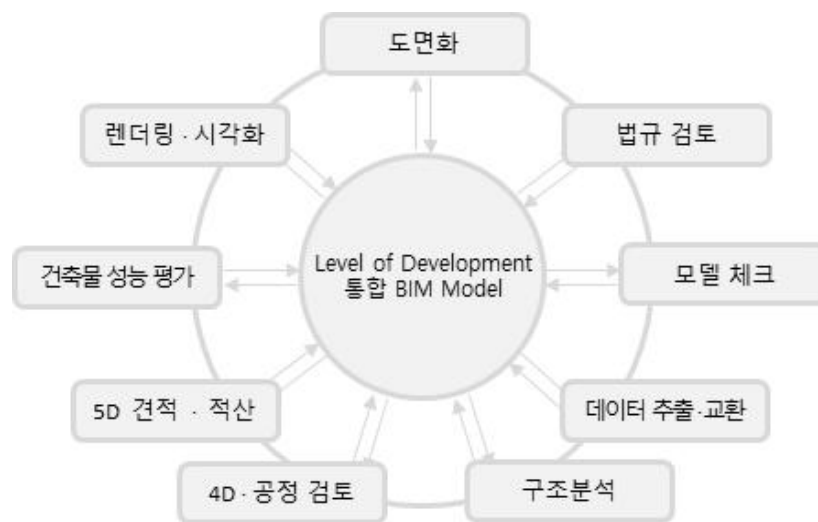
[그림 2.66] LOD 통합 BIM 모델의 활용
