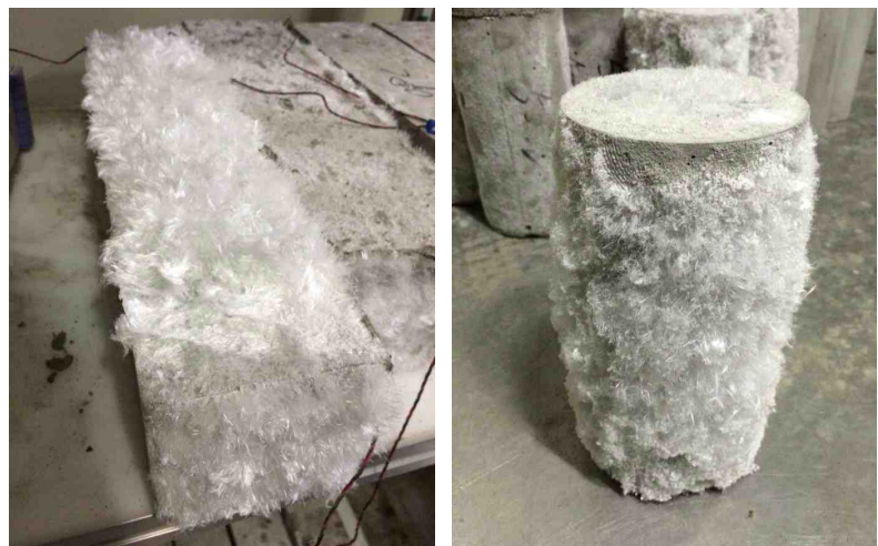
콘크리트 경화 후 요소의 용출(Flow out) 현상
