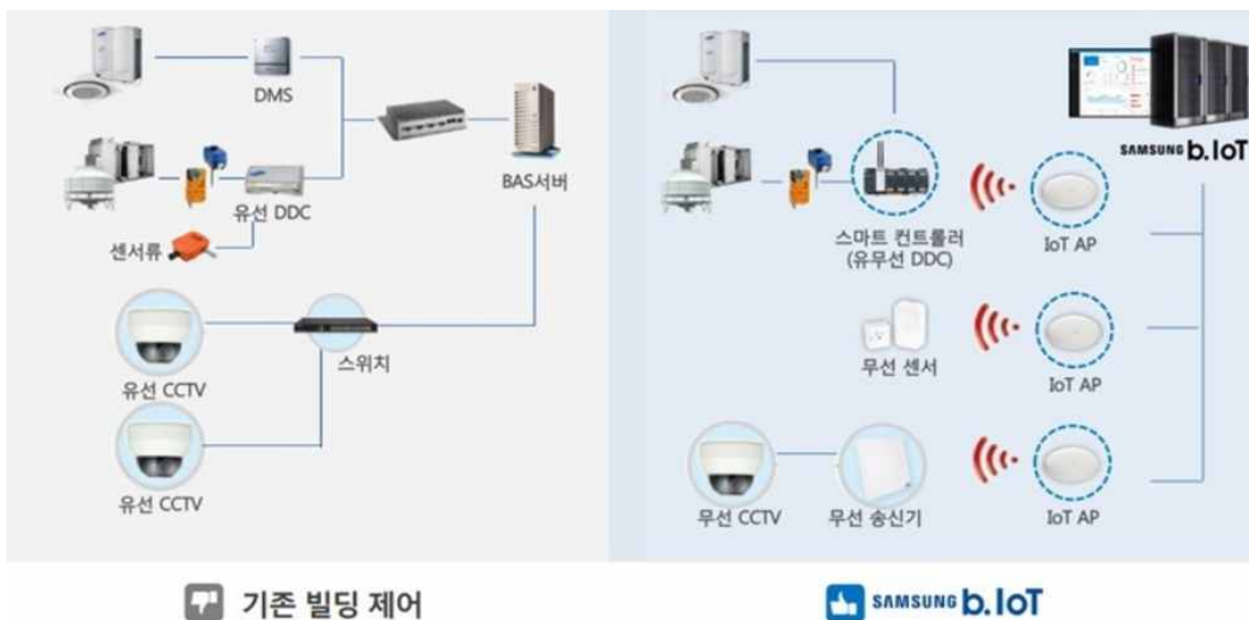
[그림 4.32] 삼성전자가 개발한 b.IoT 시스템
