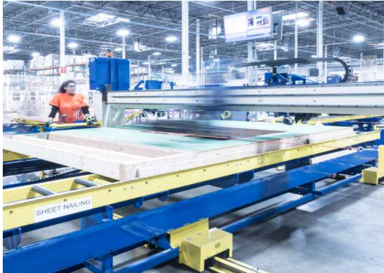
[그림 4.10] Katterra의 부재 생산 공장과 인도의 off-site 제작 사례
