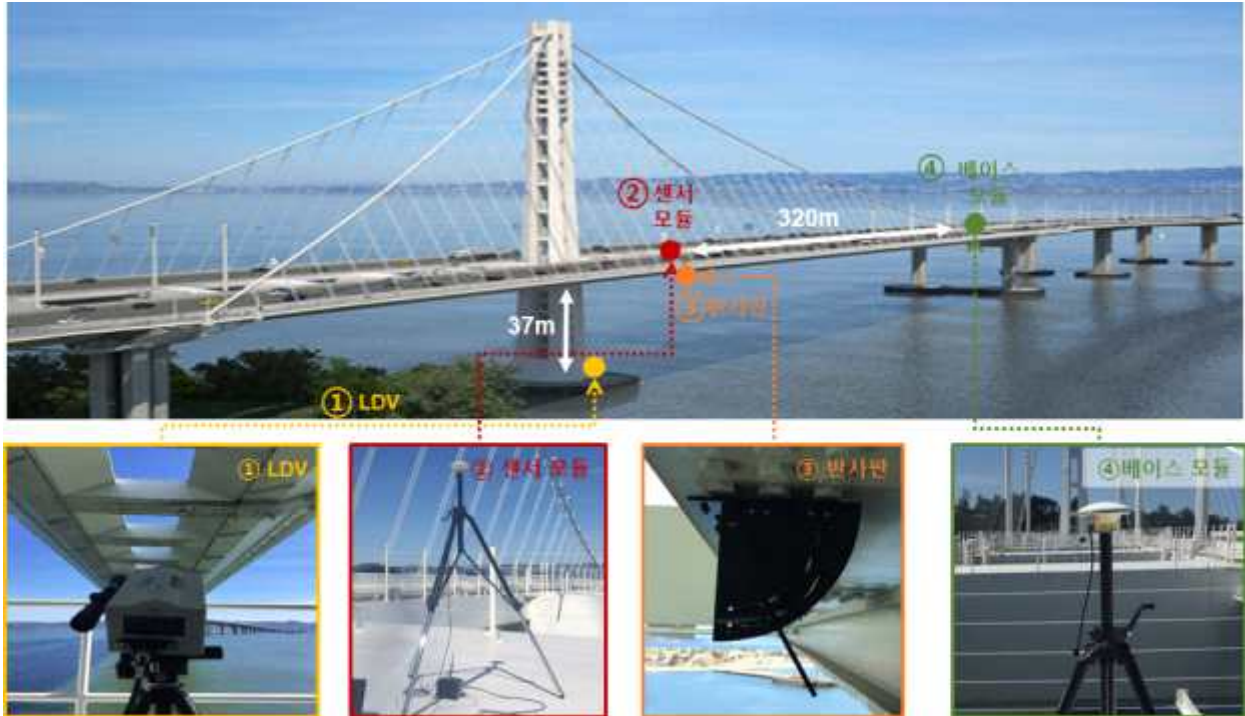
그림 51. San Francisco-Oakland Bay Bridge 성능검증 실험 개요
