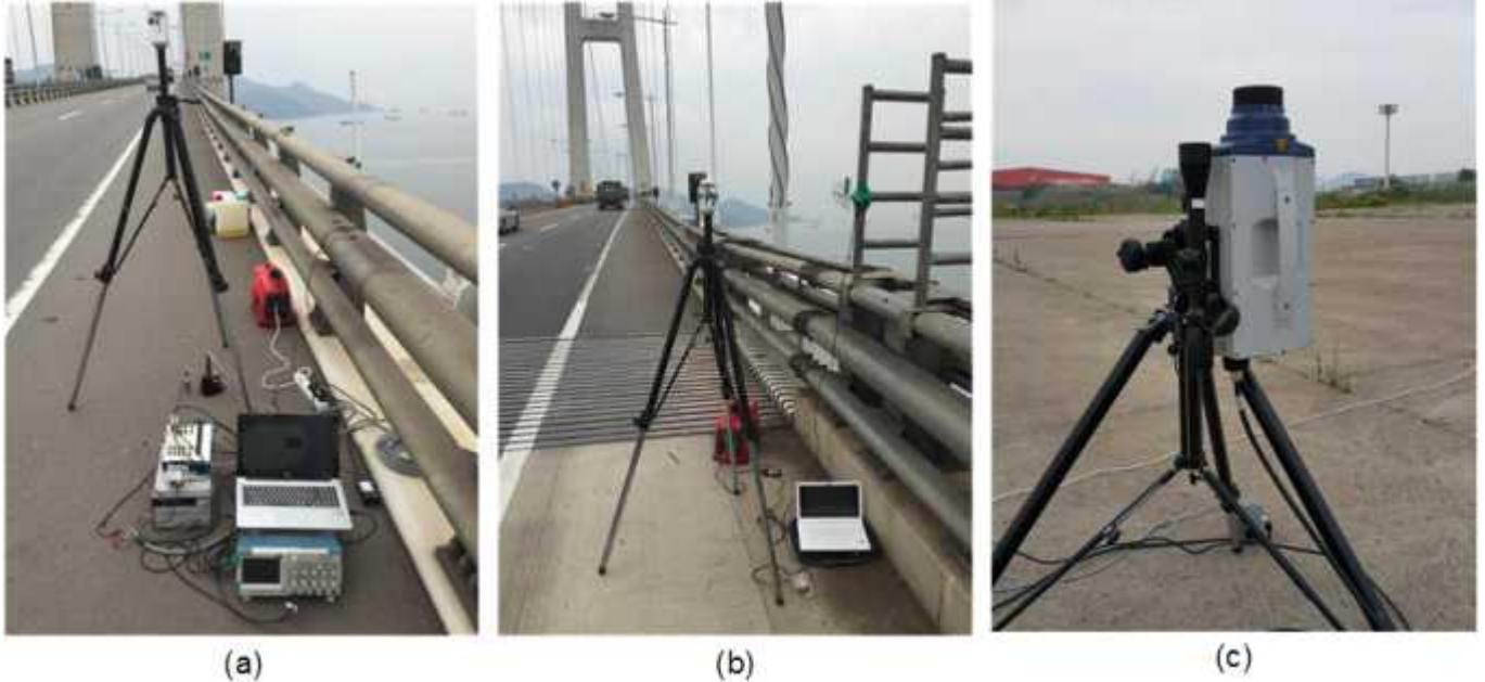
그림 28. 이순신대교 실험에 적용된 센서모듈 및 레퍼런스 변위센서, (a) 가속도계 및 rover GPS, (b) base GPS, (c) LDV
