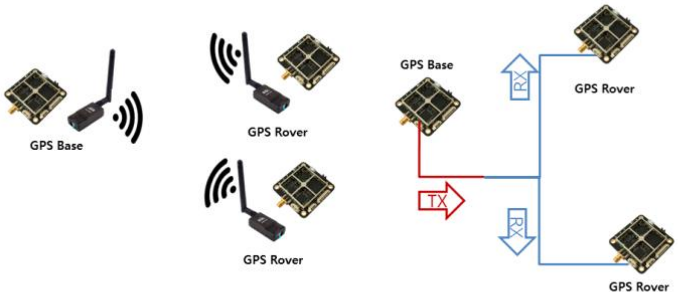
그림 35. 기존 GPS 칩셋간 라디오 기반 무선통신은 일대일 통신만 가능할 뿐 아니라 자료 손실, RTK 누락, 짧은 통신거리 등의 단점이 있으나, 본 연구에서는 UART 기반 유선통신으로 수정 변경하여 일대다 통신을 가능하게 하고 여러 단점을 해소함
