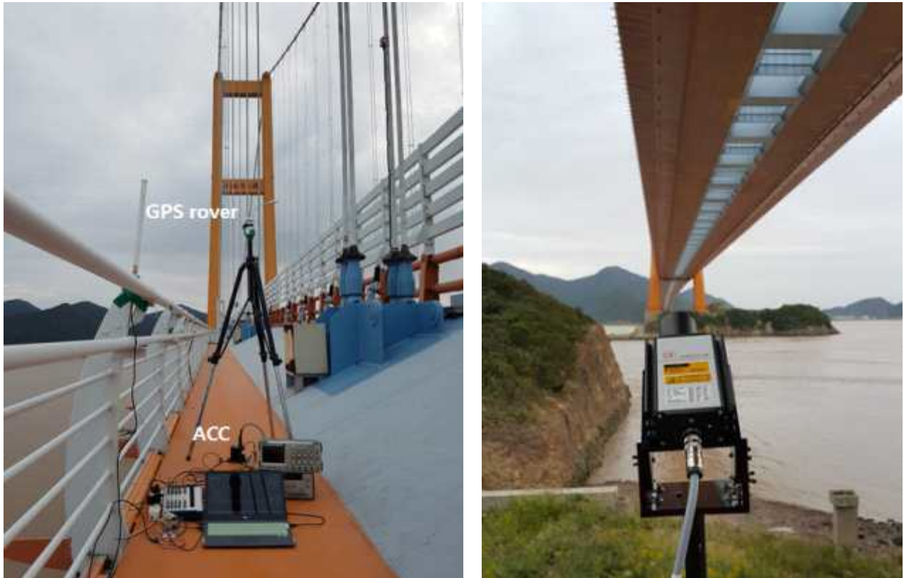
그림 30. 중국 시후멘대교 실험 전경. GPS rover와 가속도계(좌)와 장거리 레이저 변위계(우)
