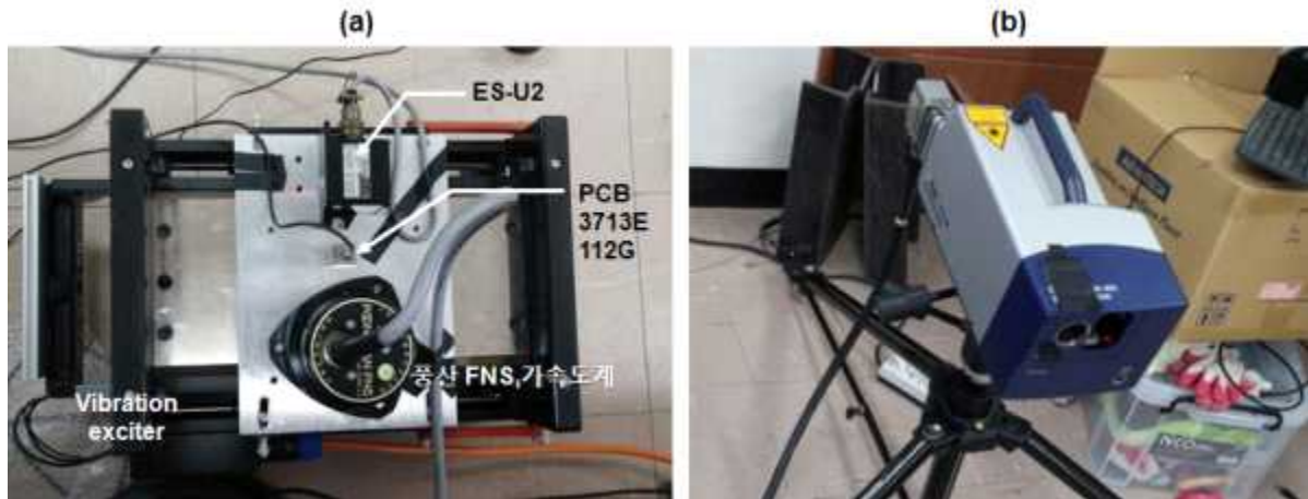
그림 6. 건설 구조물 적합성 평가 실험 구성, (a) 진동대에 설치된 개발 가속도계와 Kinemetrics ES-U2, PCB 3713E112G 가속도계, (b) reference 계측에 활용된 LDV
