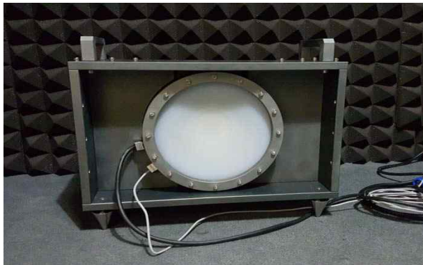
그림 2.2.1 최종결과물 고출력 수중음향발생장치 R1(500 W) (좌: 후면, 우: 전면)
