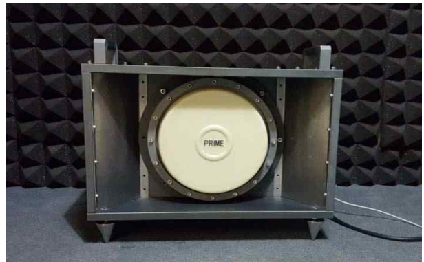
그림 2.2.1 최종결과물 고출력 수중음향발생장치 R1(500 W) (좌: 후면, 우: 전면)
