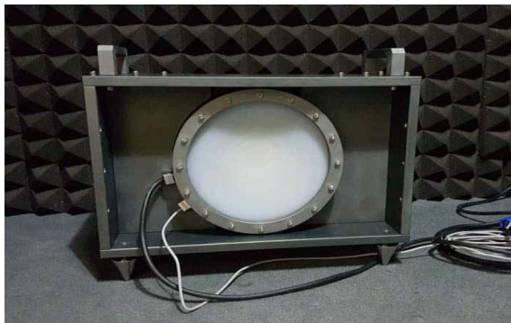
그림 3.2.10 최종결과물 고출력 수중음향발생장치 R1(500 W)(좌: 후면, 우: 전면)
