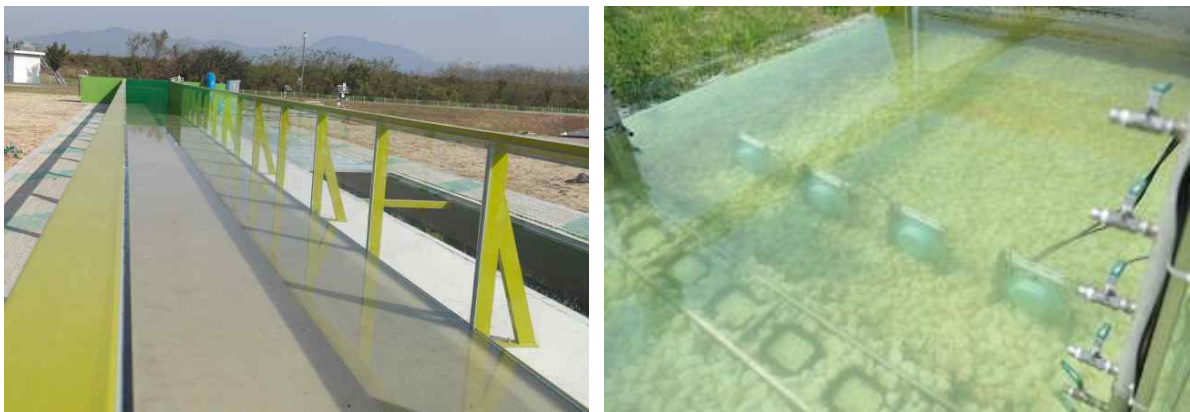
그림 3.2.24 어류거동 실험수로 및 음향발생기
