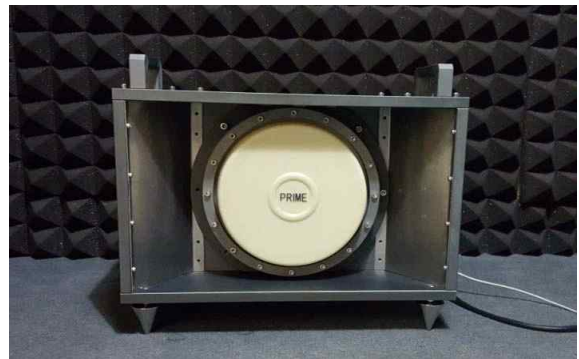
그림 3.2.10 최종결과물 고출력 수중음향발생장치 R1(500 W)(좌: 후면, 우: 전면)
