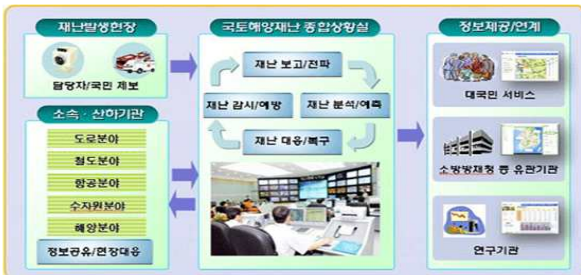
그림 109 국토교통부 종합상황관리 시스템 구성도
