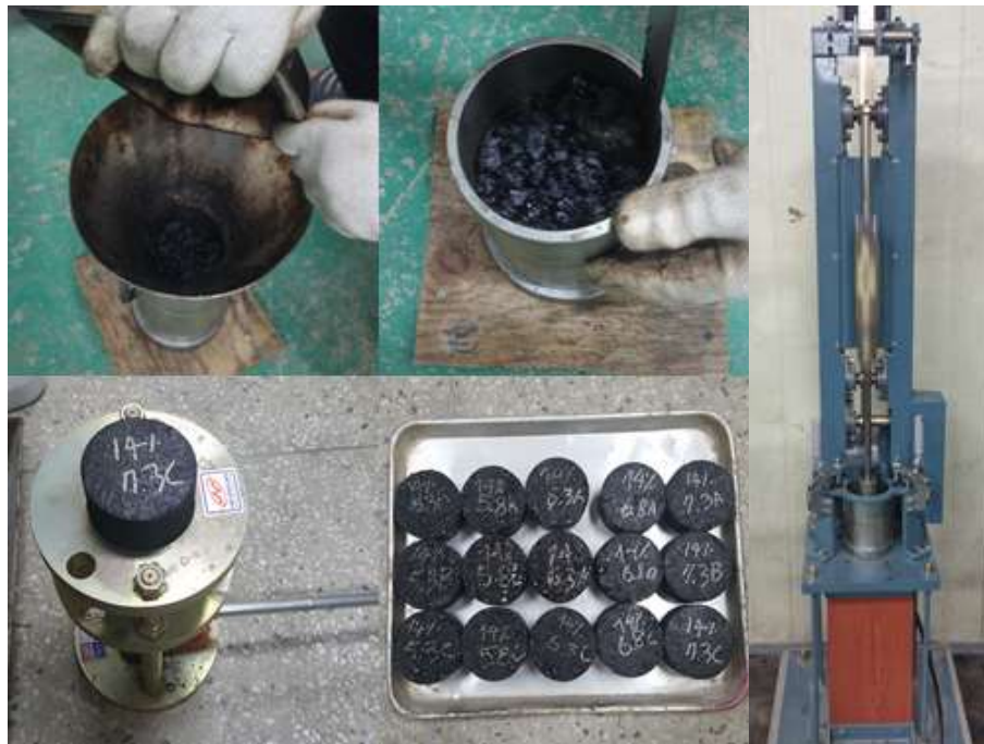
그림.33 마샬 다짐기와 마샬 공시체 제작 과정
