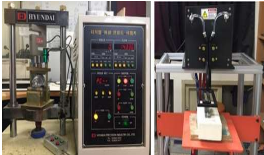
그림.63 인장강도 시험기, 유도가열 시험기
