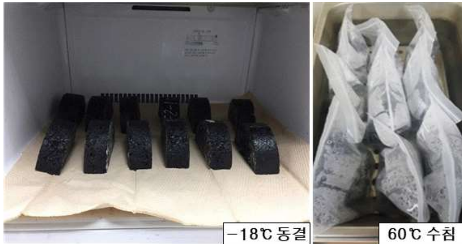
그림.68 시험 시편 동결 및 융해 과정
