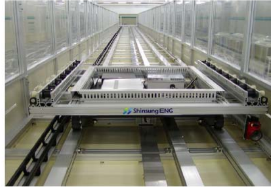
그림 2-9. 한국전기연구원이 개발한 30kW급 CPS
