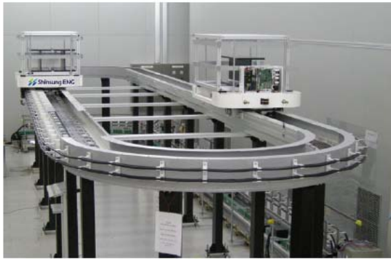
그림 2-9. 한국전기연구원이 개발한 30kW급 CPS
