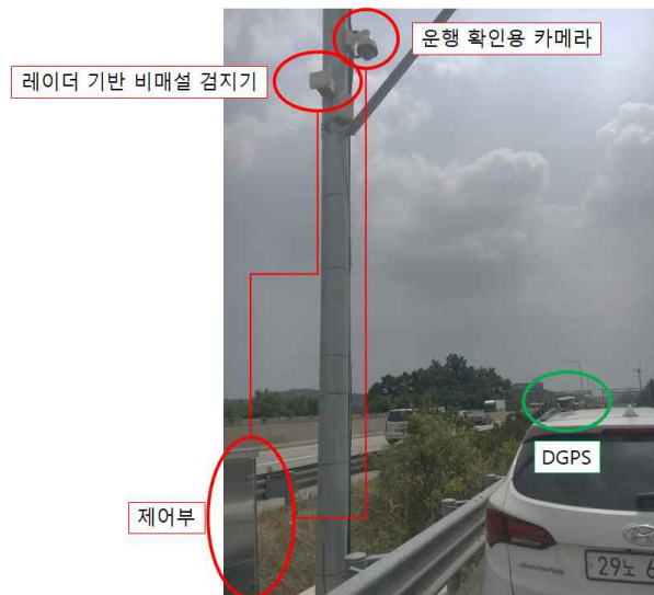
[그림 62] 매칭 테스트 장비 구성
