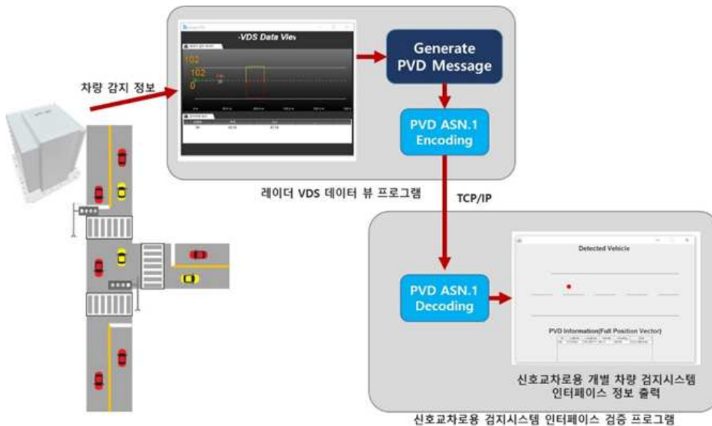
[그림 61] 비매설 검지시스템 기반 PVD 메시지 인코딩/디코딩 결과
