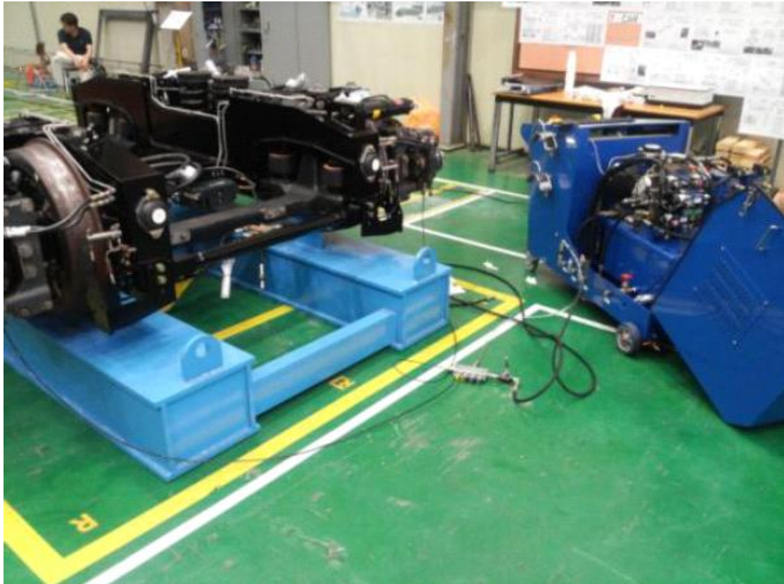
트램차량 플러싱 작업
