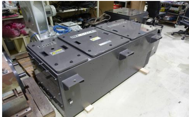
VVVF 인버터 BOX 사진
