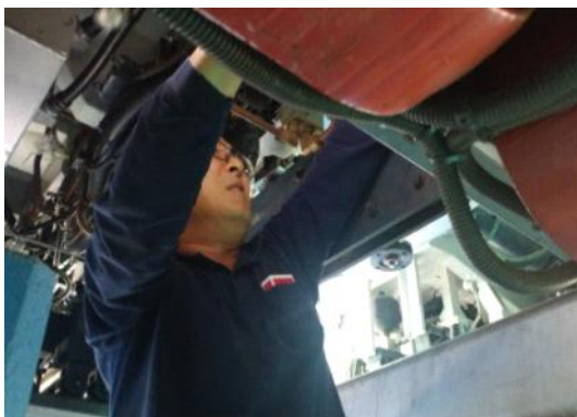
기존 롤러 시스템 분리작업
