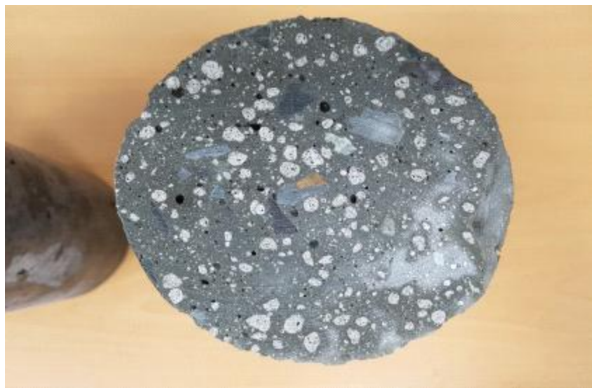
그림 x . 개발 잔골재를 이용해 제작한 콘크리트 샘플 단면
