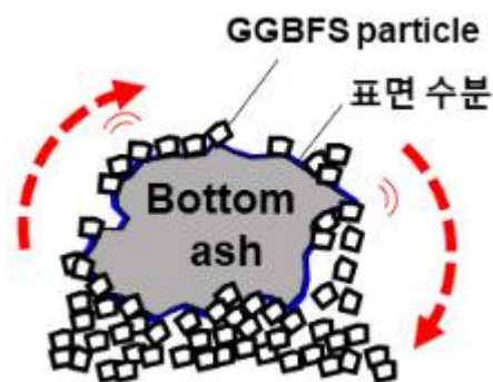
그림 x. 입자 형성 과정 모식도
