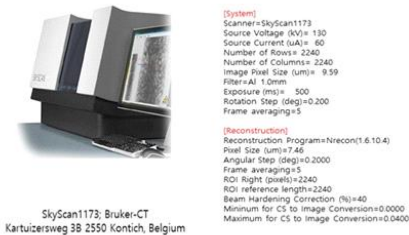
그림 x. Micro-CT 장비 및 본 연구에서 사용한 측정조건
