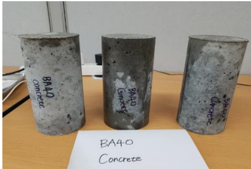
그림 x . 개발 잔골재를 이용해 제작한 압축강도 측정용 콘크리트 샘플
