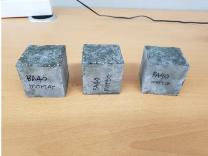
그림 x . 개발 잔골재를 이용해 제작한 압축강도 측정용 모르타르 샘플
