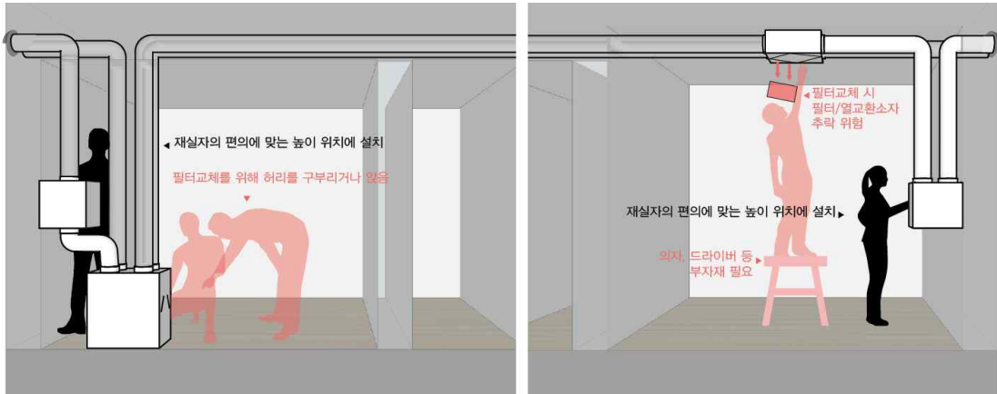
[그림 65] 상하토출형 프리필터 시스템과 상부토출형 프리필터 시스템 설치 예시도
