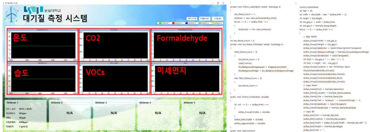
[그림 57] 대기질 측정 시스템 소프트웨어 및 개발된 C code 예시
