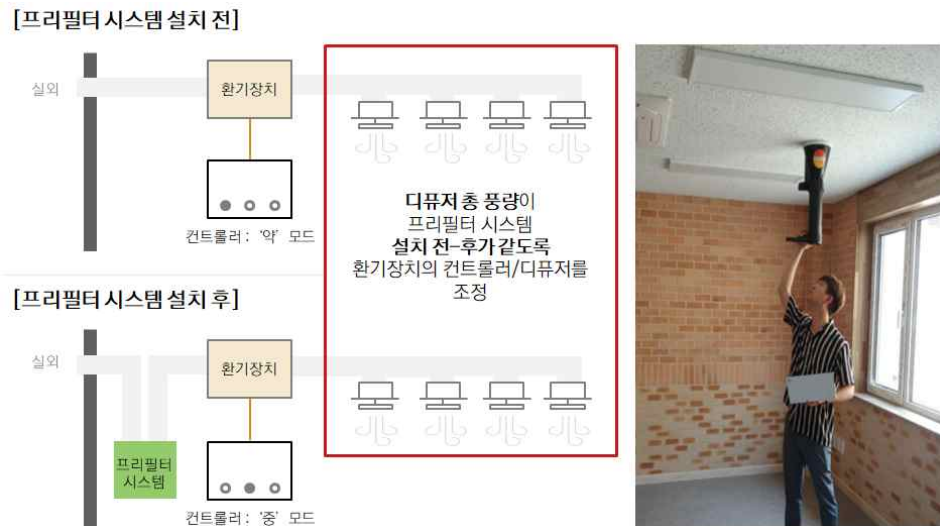
[그림 64] 프리필터 시스템 설치에 따른 TAB수행 방법
