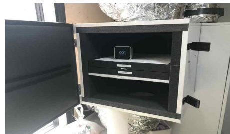
[그림 68] 프리필터 시스템 내부 필터통과 후 미세먼지 측정값 (1)
