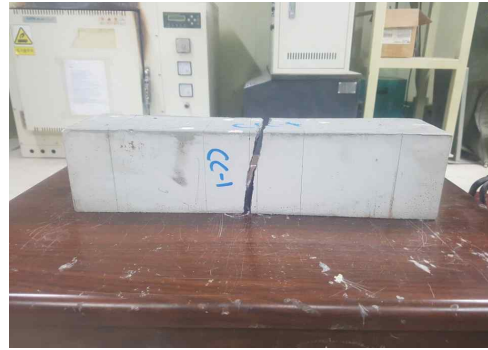
(b) 콘크리트 파괴형상
