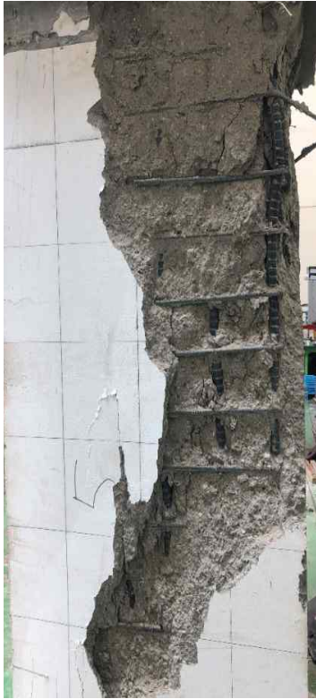
(d) Cross-tie anchoring
