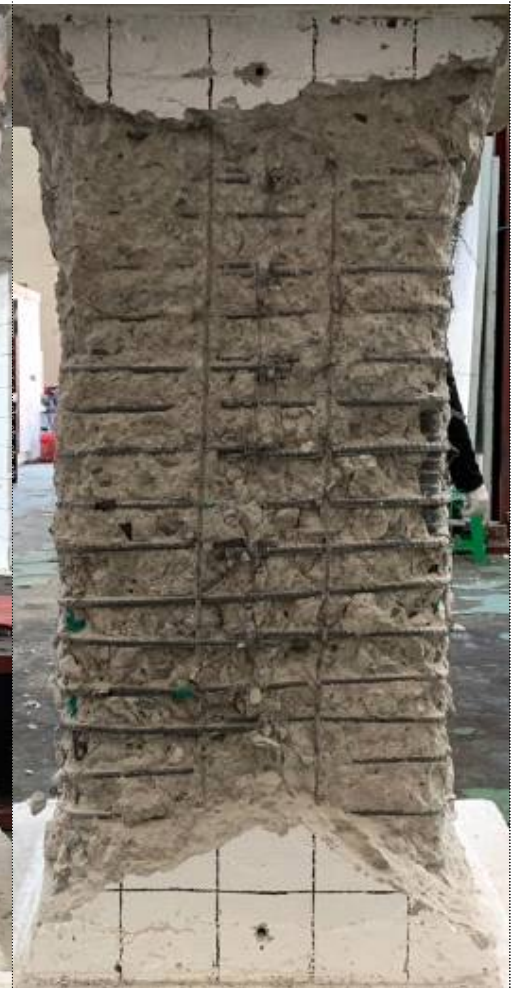
(d) Section maintain strengthening ( 2.0 A_{sh} )
