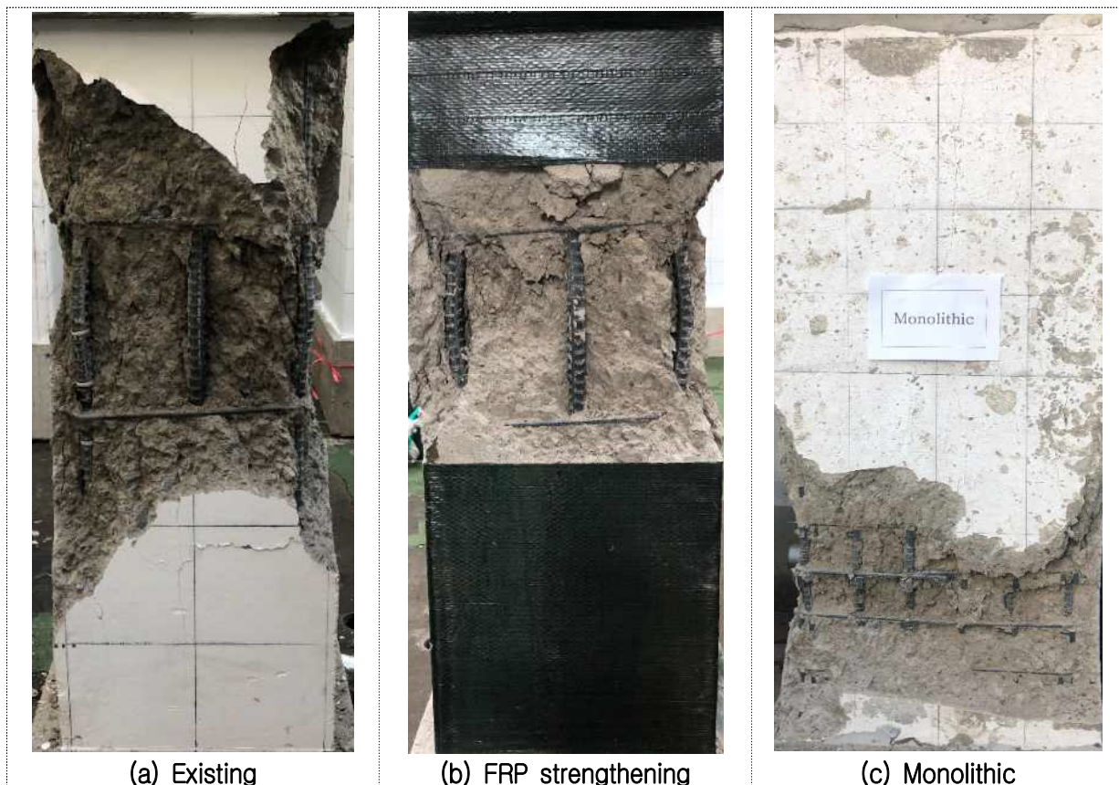
그림 2.30 중심축하중 실험 파괴모드:제시된 공법 기둥
