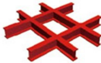
〈그림 II-25〉 H형강을 격자로 구성한 TVS 공법의 개념
