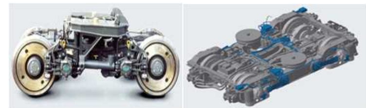
그림 2.52 ECO4 Train의 경량화 및 지능화 대차 설계기술
