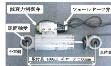
그림 2.19 능동 2차상하현가장치 시스템
