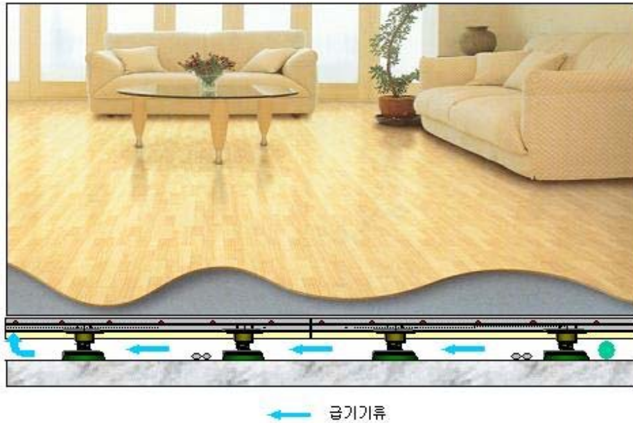
[그림 1.2.1] 다기능 통합온돌시스템의 설치 개념도
