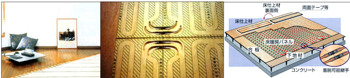
[그림 2.2.1] 일본의 조립식 온돌패널 시스템의 예
