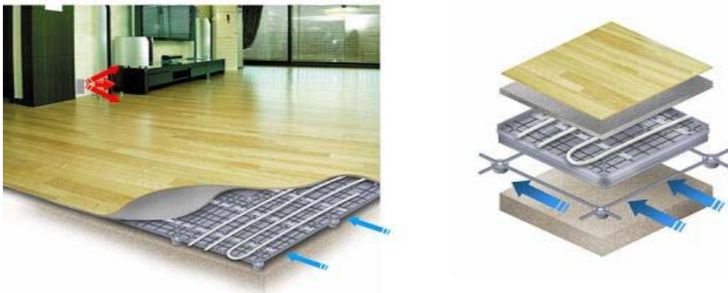
[그림 3.4.1] 이중바닥 온돌시스템의 하부공간을 이용하는 환기개념
