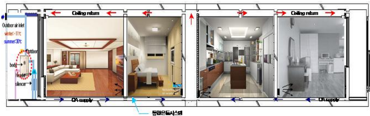
[그림 1.2.4] 이중바닥온돌시스템을 이용한 무덕트슬림형 자연환기시스템 개념도
