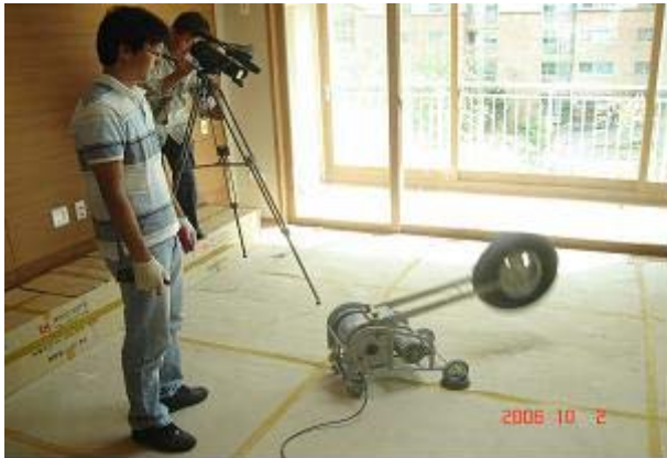
[그림 3.2.6] 충격음 시험 장면
