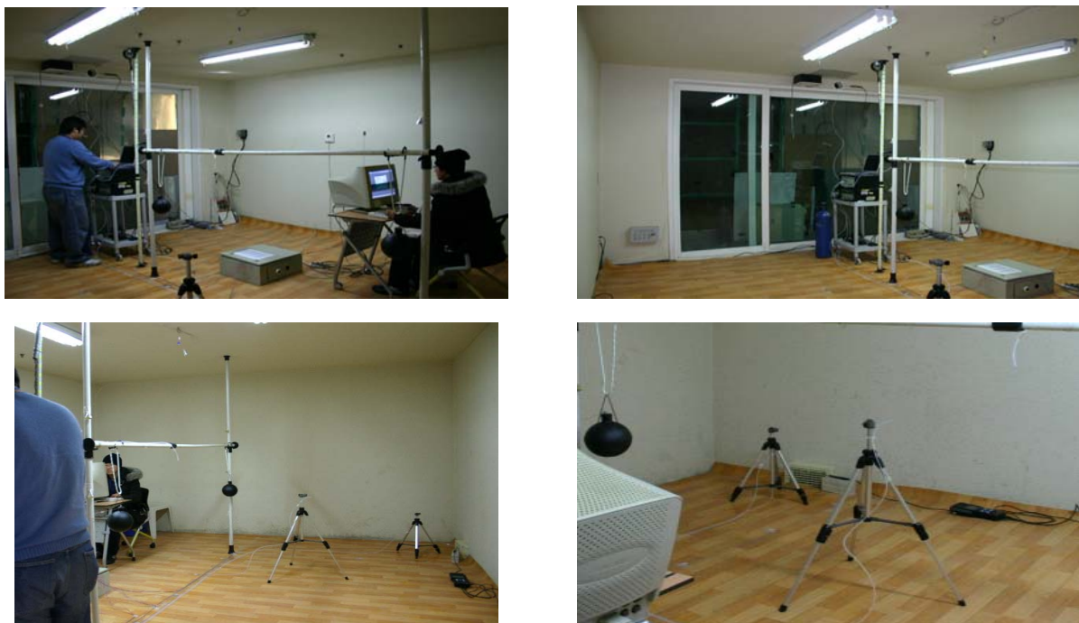
[그림 3.4.6] 실물실험실내에서의 환기실험 장면
