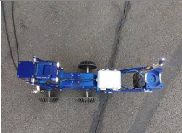
a. 가스탐지기 장착(탈부착 멀티유닛)
