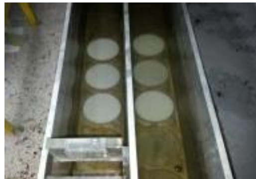
[그림 2-9] 수중 유실 저항성능 시험
