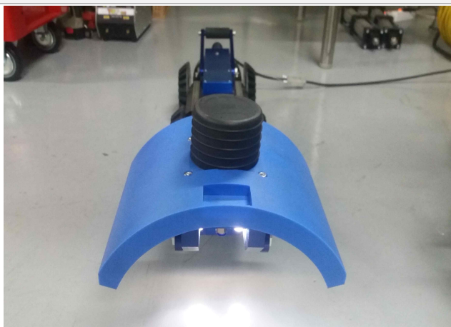
b. 분기관 보수 브라켓 장착(탈부착 멀티유닛)
