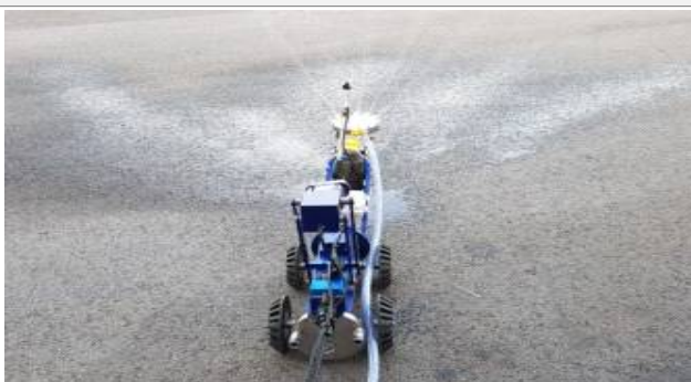
b. 방역장치 장착(탈부착 멀티유닛)
