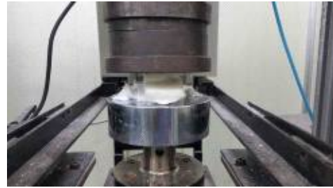
[그림 2-6] 압축강도 시험
