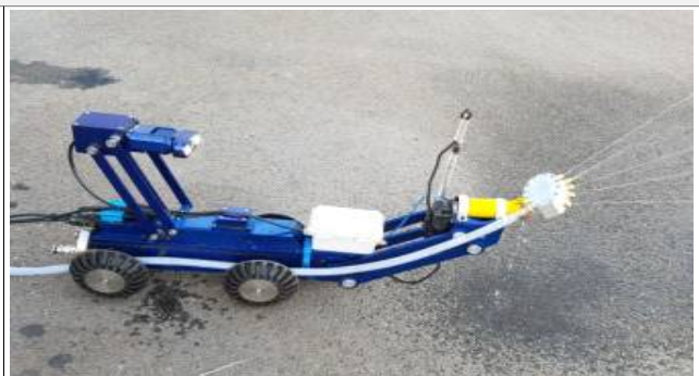
b. 방역장치 장착(탈부착 멀티유닛)
