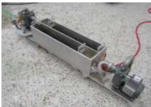
[그림 2-9] 수중 유실 저항성능 시험
