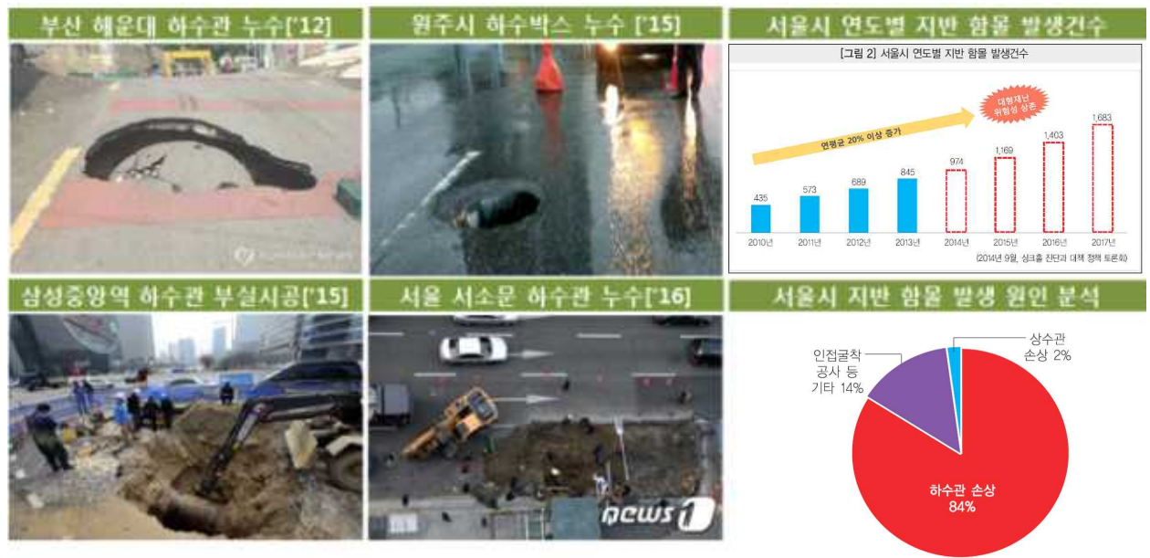
[그림 1-1] 지반함몰 사례 및 원인 분석(출처: 싱크홀 진단과 대책 정책 토론회)
