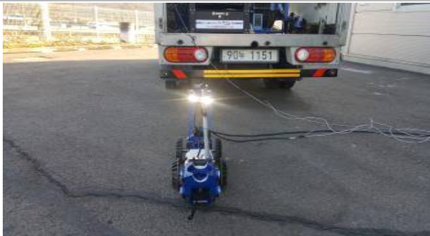
b. 내시경 카메라 장착(탈부착 멀티유닛)
