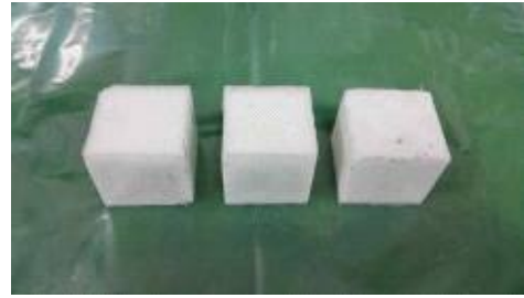
[그림 2-5] 압축강도 시험 시편 제작
