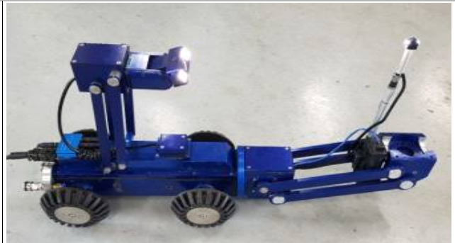
b. 내시경 카메라 장착(탈부착 멀티유닛)
