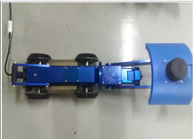
b. 분기관 보수 브라켓 장착(탈부착 멀티유닛)
