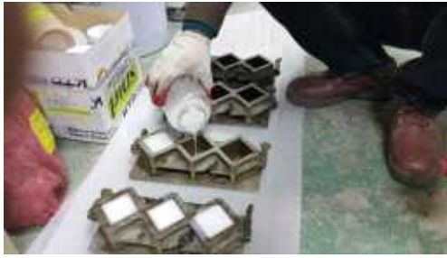
[그림 2-5] 압축강도 시험 시편 제작
