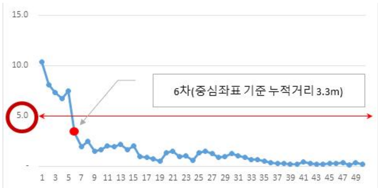
<그림> 도심지(안양법원) 측정횟수별 중심좌표 기준 누적거리 편차 분석 결과
