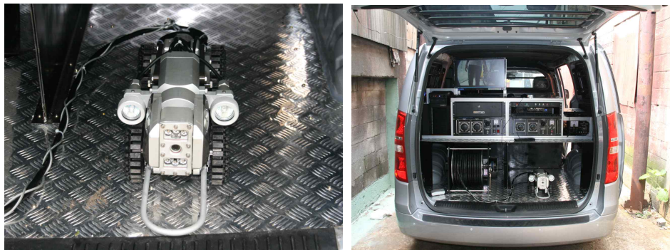
그림 8. 관로 cctv 조사차량 및 실시간 모니터링 시스템
