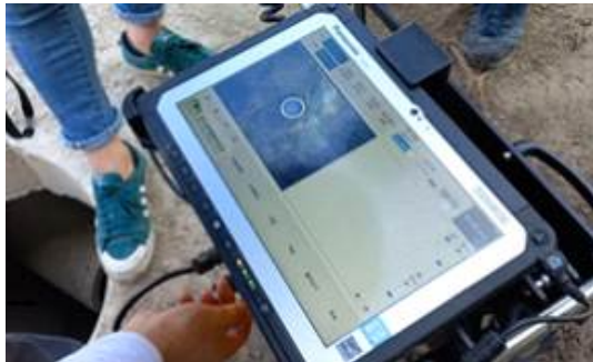
③ 공동 내부 내시경 탐사
