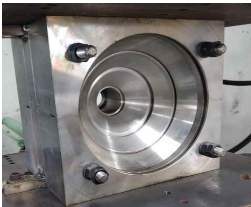
③ 압력커튼 상·하부 금형 조립
