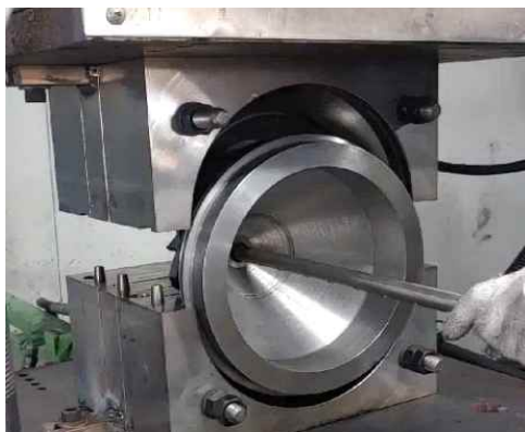
⑤ 압력커튼 상·중·하부 금형 조립(정면)
