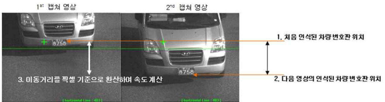
그림 128 영상속도 측정을 위한 기본 개념설계
