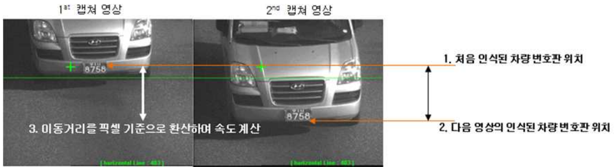
그림 19 영상속도 측정을 위한 기본 개념
