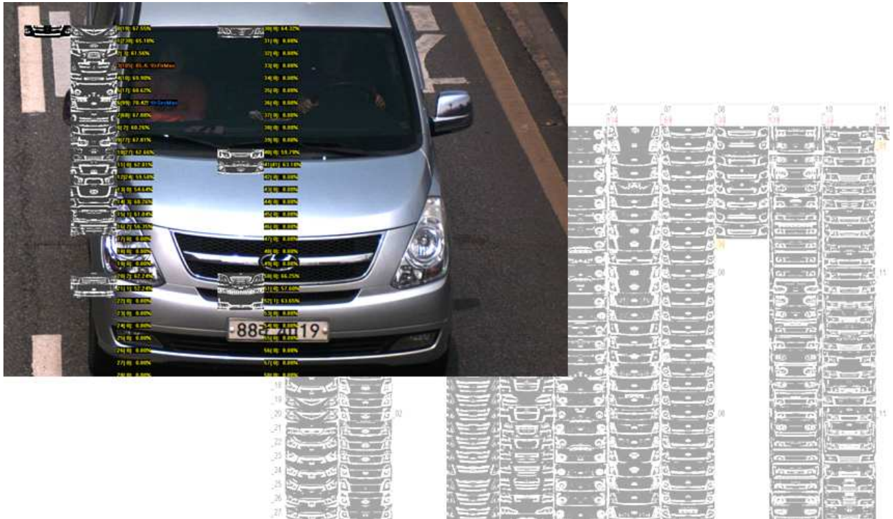
그림 132 차량모양에 따른 화물차 차종인식 알고리즘 구현
