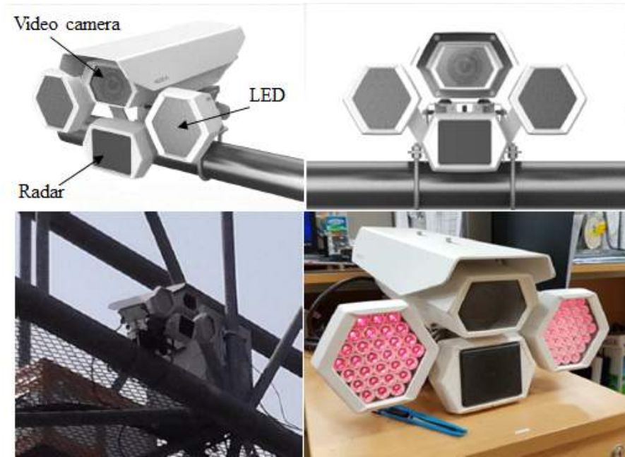
그림 95 일체형(Onebody) 영상-레이더 단속 장비 (1차년도)
