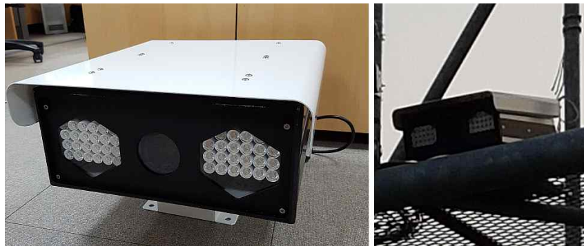
그림 96 일체형(Onebody) 영상-레이더 단속 장비 (2차년도)
