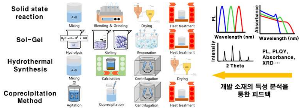
그림 3. 자체 발광형 소재 분말 합성공정 및 특성분석을 통한 피드백
