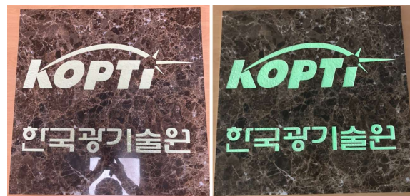
그림 34. 시작품 제작 전 prototype 제작 (좌) 실내등 하 (우) 내부 광원 제거
