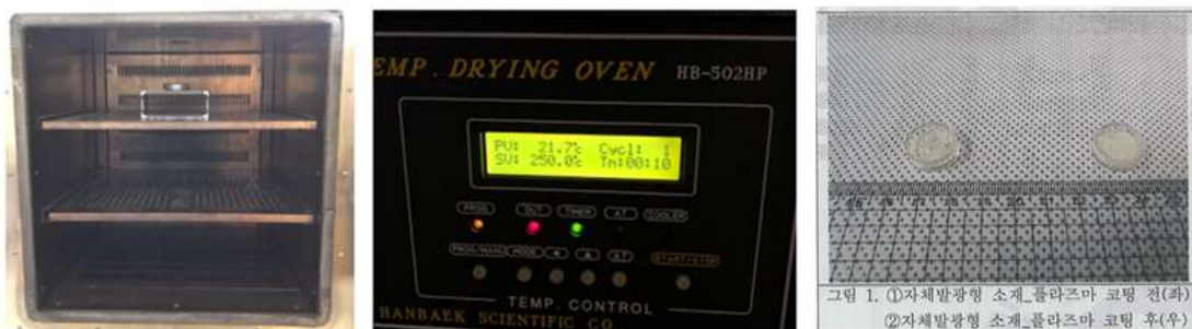
그림 32. 내열성 시험 (좌) 시험 장비 (중) 시험 조건 (우) 시험 시료
