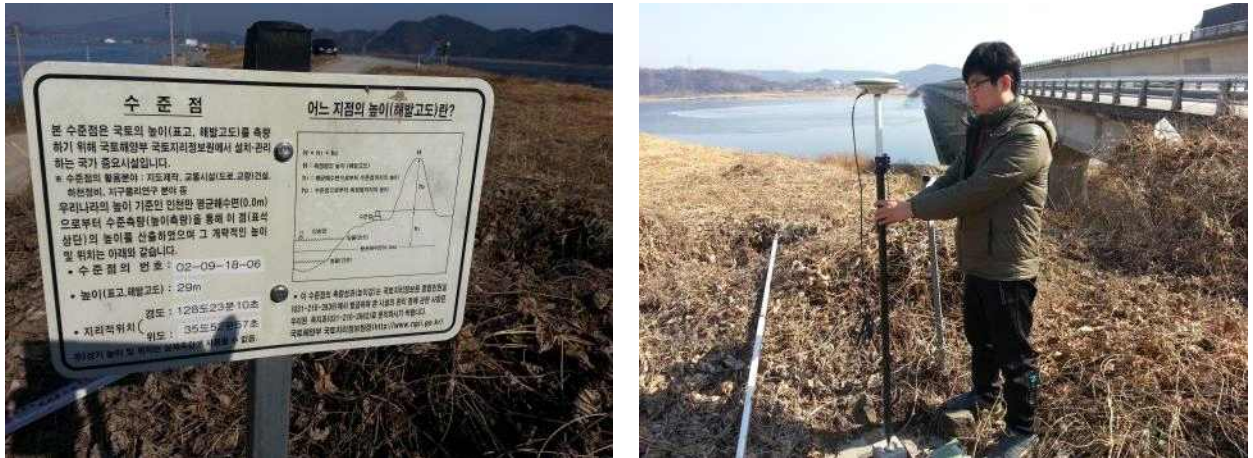
그림 2.145 하천에서의 현장실험 대상지역의 수준점 측량
