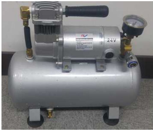
그림 2.71 채수 컨테이너의 가압 및 제어장치
