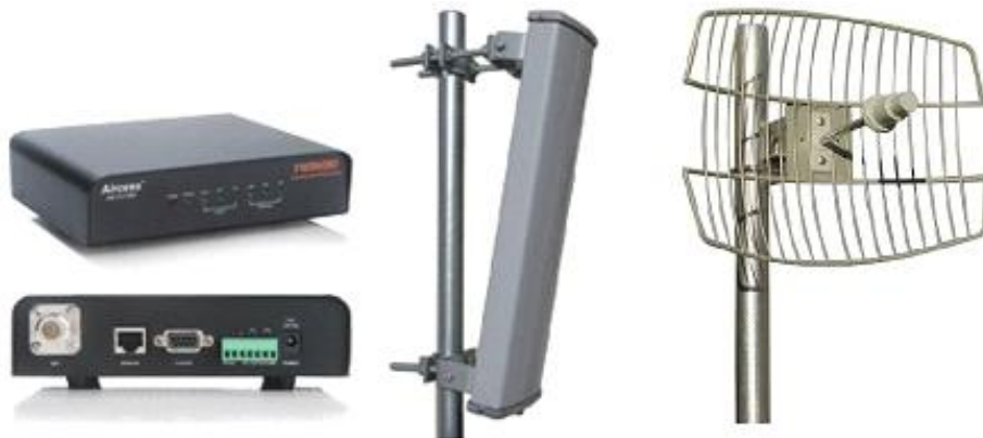
그림 2.39 RF 통신 모뎀 및 송수신 안테나
