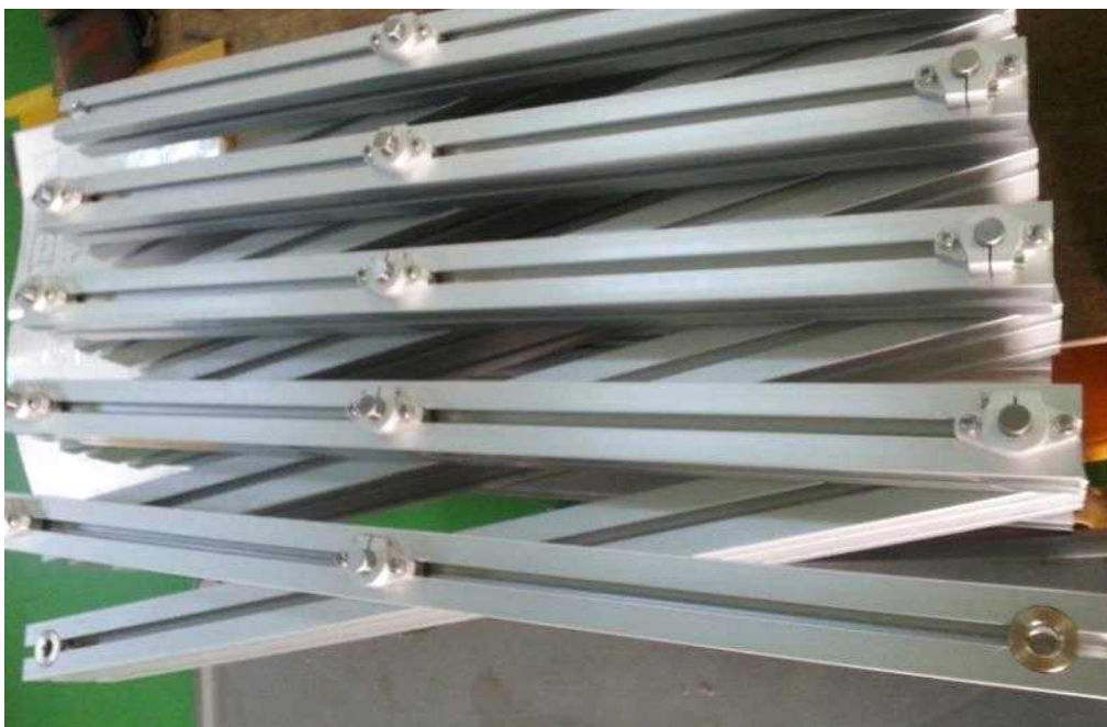
그림 2.111 채수 리프트의 관절 제작공차에 의한 처짐현상
