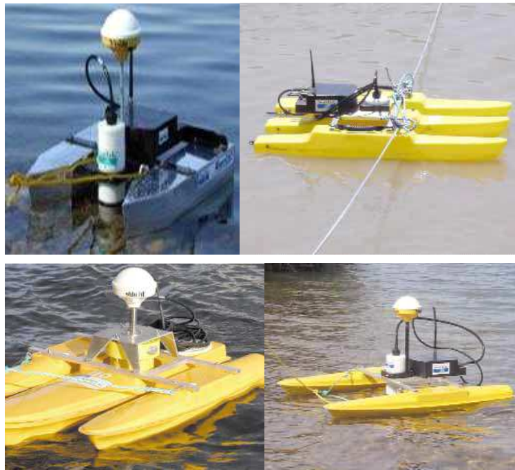
그림 2.13 SonTek사의 유량측정 장치
