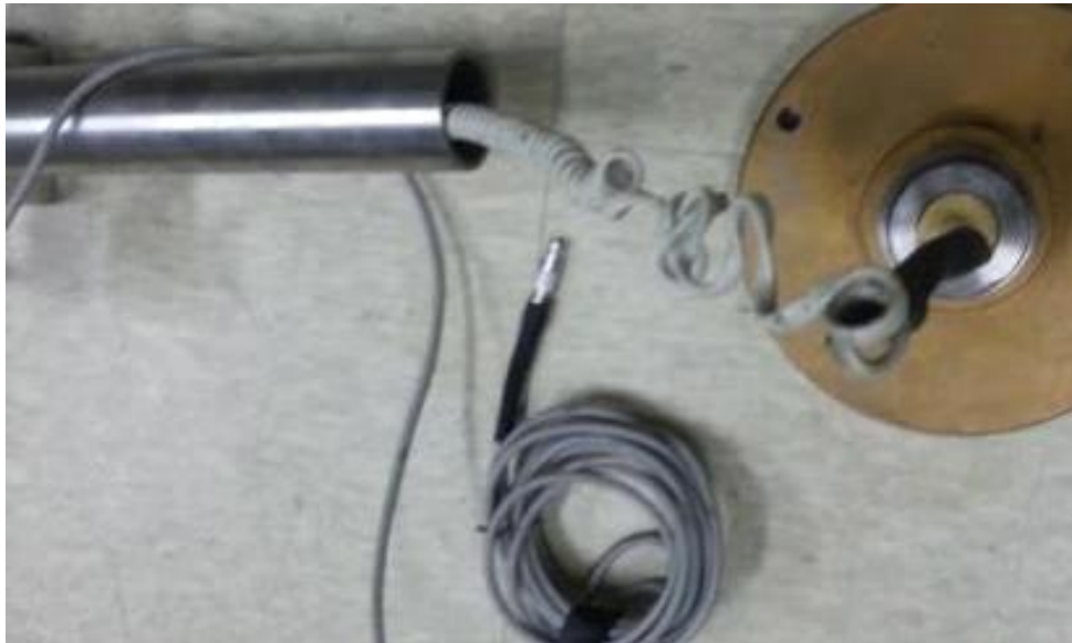
그림 2.98 음향측심기 데이터 케이블 개선 결과
