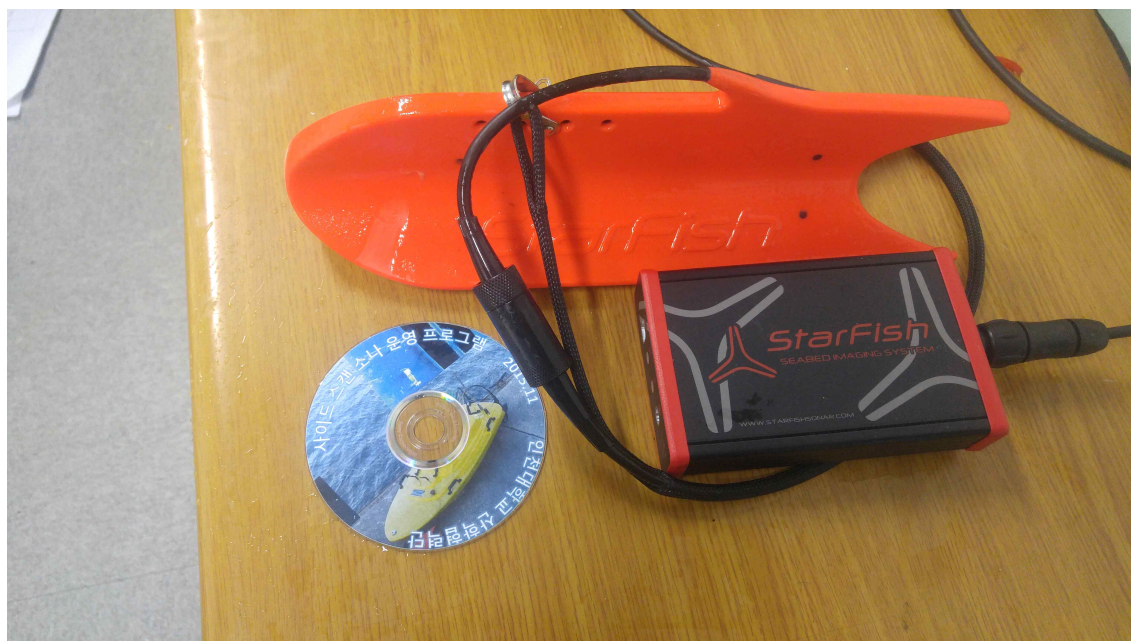
그림 2.38 하상정보 수집을 위한 음향측정 센서
