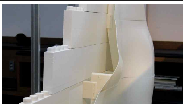
실내 시험 시공된 비정형 패널(측면)
