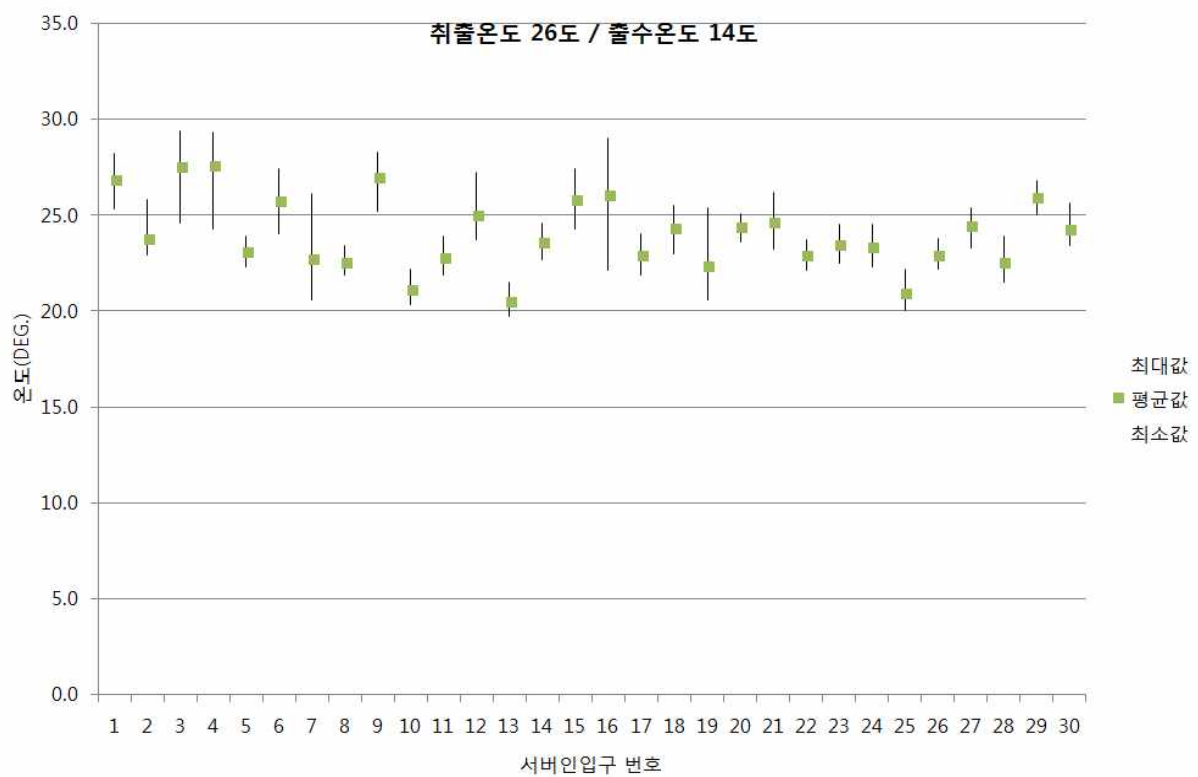
[그림 2.5.60] 출수온도 14°C, 급기온도 26°C인 경우 서버 인입온도 분포
