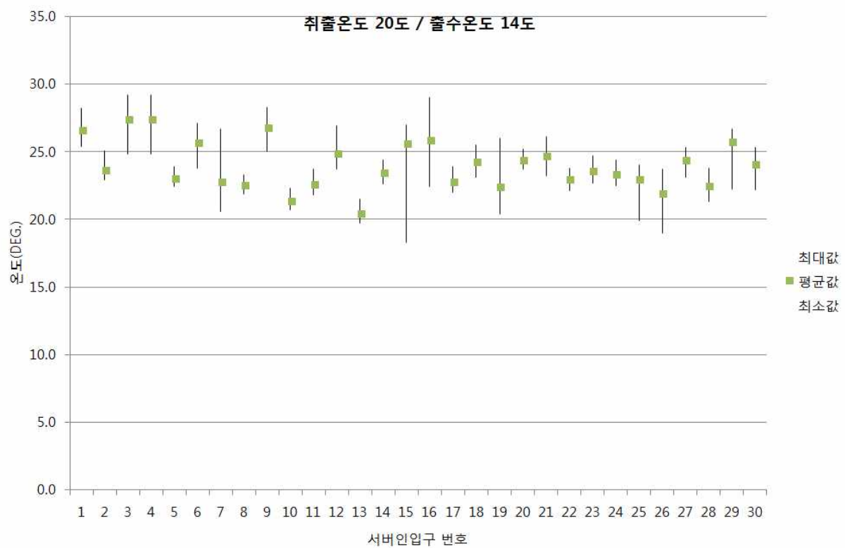
[그림 2.5.57] 출수온도 14°C, 급기온도 20°C인 경우 서버 인입온도 분포
