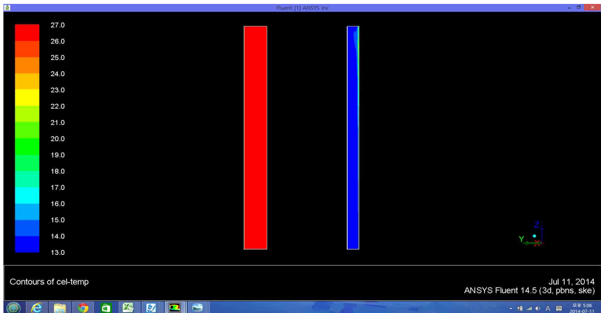
[그림 2.4.8] 밀폐형 랙에서의 온도 분포 (급기쪽 공기유입로 폭 : 10cm)
