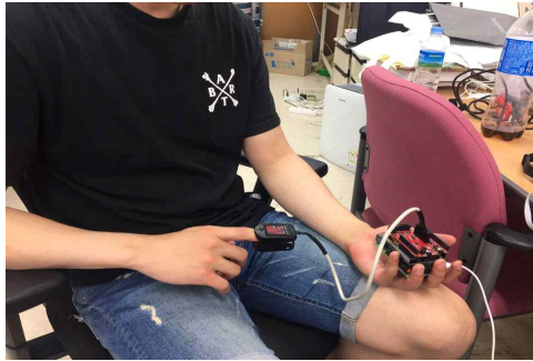
그림 17. 라즈베리파이를 이용한 심박 수 측정
