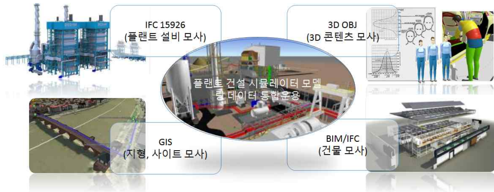
<그림 2.57> 건설 플랜트 시뮬레이터 통합 데이터 운용
