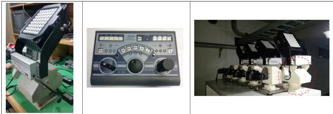
〈그림 2-4〉 조명 원격 조종 모듈(팬틸트헤드+컨트롤러)
