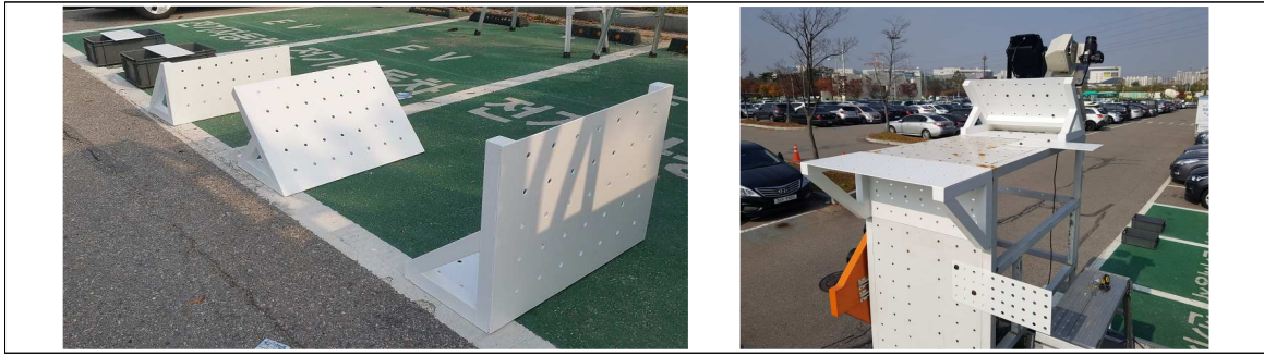
〈그림 2-14〉 제작된 브래킷 및 익스텐더(좌), 프레임에 장착된 브래킷 및 익스텐더(우)
