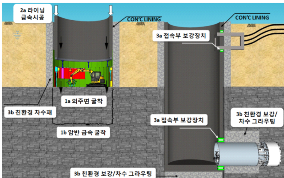
<그림 1.1.15> 제안 수직구 시공 시스템의 개요
