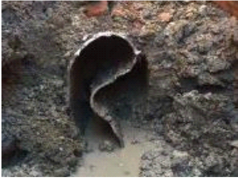
<그림 1.1.4> 지진시 액상화에 의한 하수관거 붕괴
