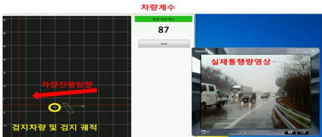
[그림 44] 운영화면(좌:레이더 검지 결과, 중:차량계수 결과, 우:실제 통행량 영상)
