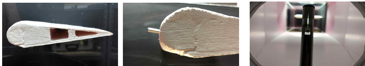
그림 2.28 간이 풍동실험에 사용된 Clark-Y 에어포일 형상 집풍장치 단면과 기류 측정
