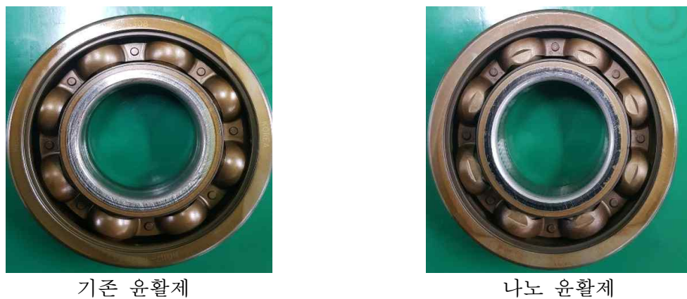
그림 3-4-12. 시험 후 베어링 내부 (900시간)
