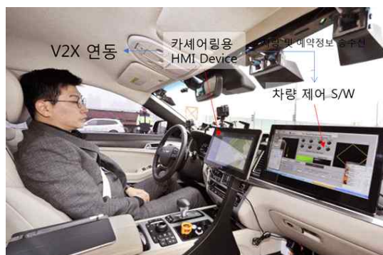
[그림 109. SKT G80 자율주행차량 시스템 구성]
