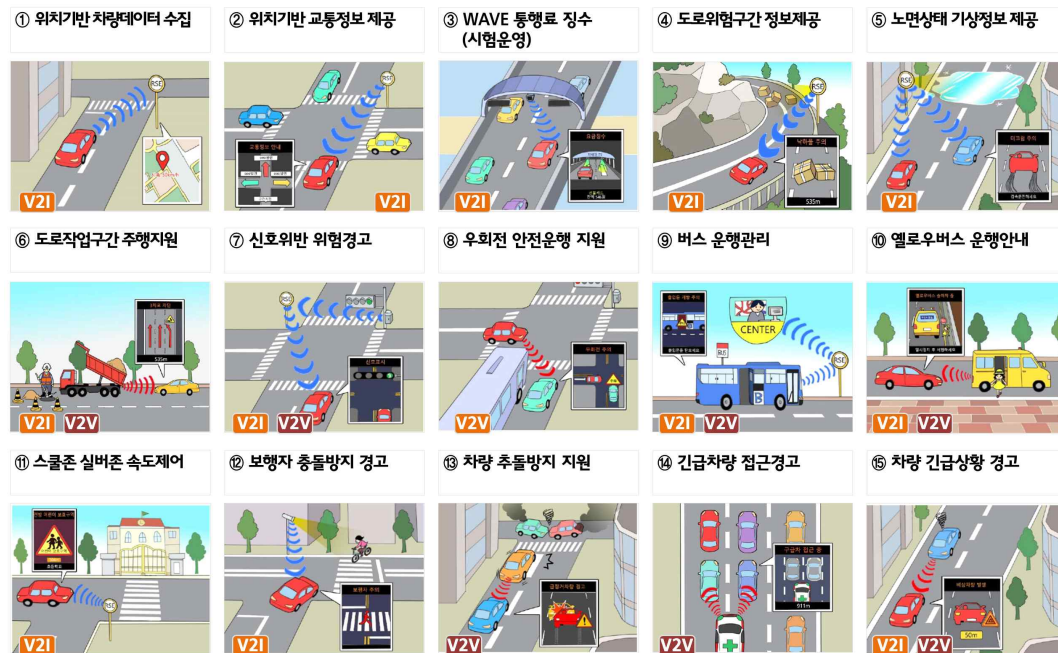
[그림 23. C-ITS 개념도 및 서비스]
