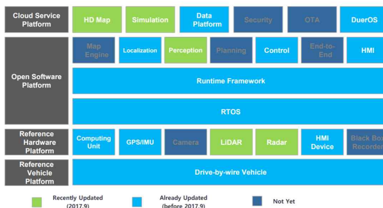
[그림 15. 자율주행 Framework 구조]
