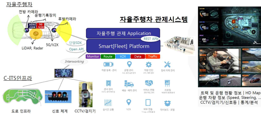
[그림 3. 자율주행차 기반 카셰어링 관제 시스템 개념도]
