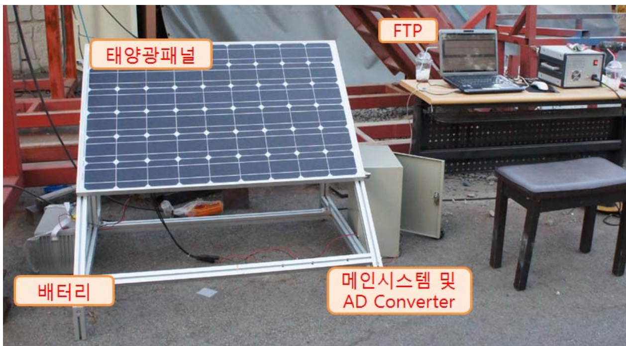
그림 5.4 토석류 축소모형실험 현장에 적용된 실시간 무인계측 감응시스템 전경
