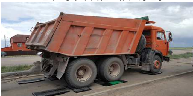
▲ 현지 이동식 과적 검문소 검차 측정 현장
