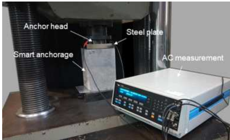
그림 5-9. 스마트 콘크리트 정착구 실험 전경
