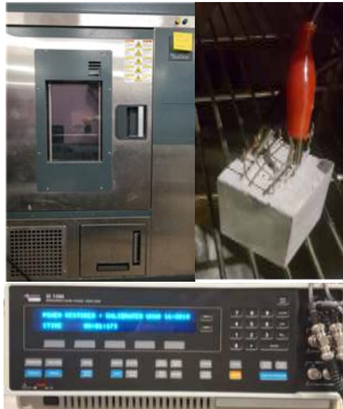
그림 2-1. 온도와 습도 영향성 평가 실험 전경
