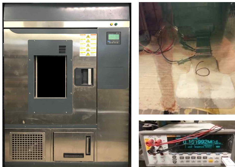
<온도와 습도 변화에 따른 전기적 거동 실험 전경>
