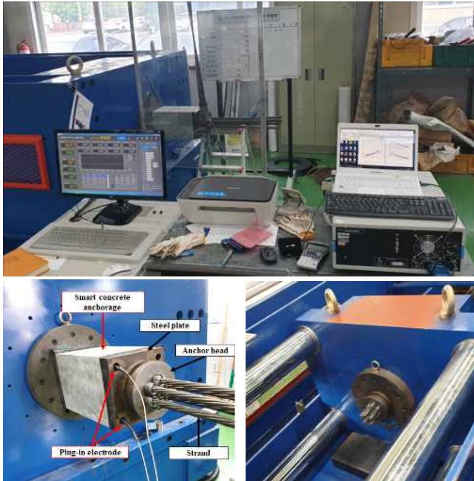
그림 5-13. 긴장력 손실 모니터링을 위한 스마트 콘크리트 정착구 실험 전경
