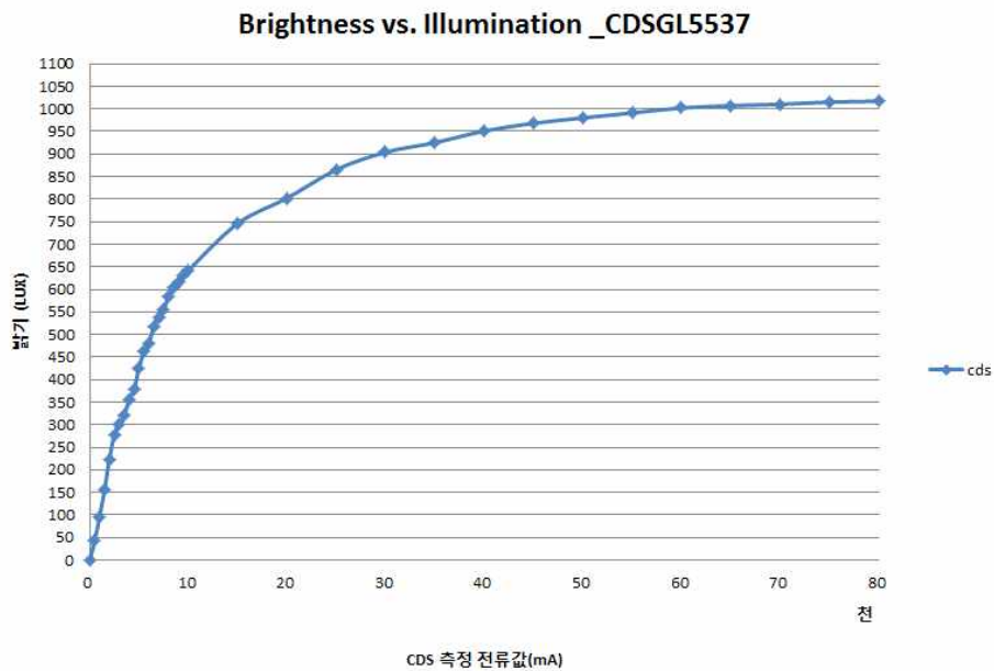
그림 3-2-27. CDS 센서값 대비 밝기의 상관관계
