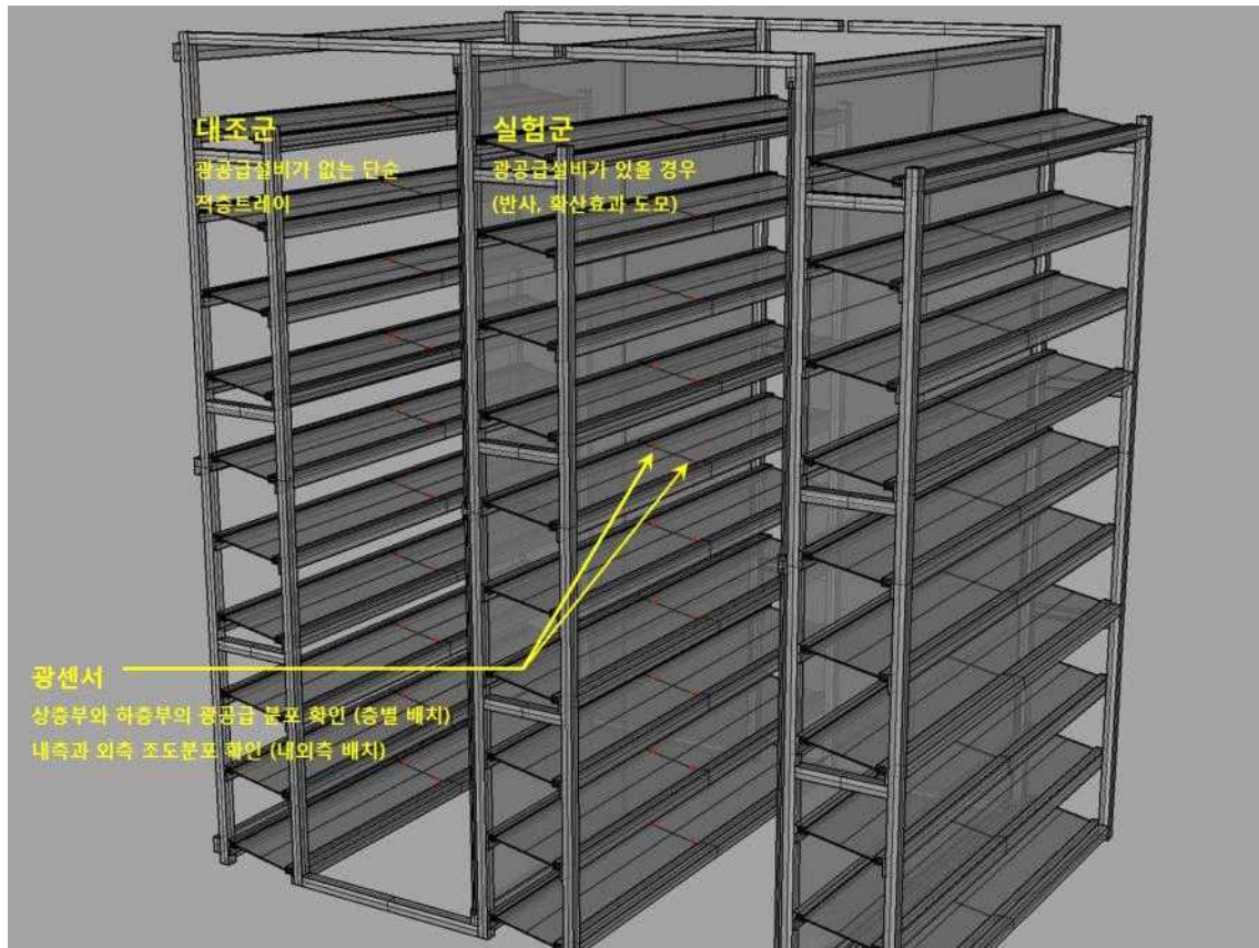
그림 3-2-24. CDS 조도센서 실험군 및 대조군 설치 개념도
