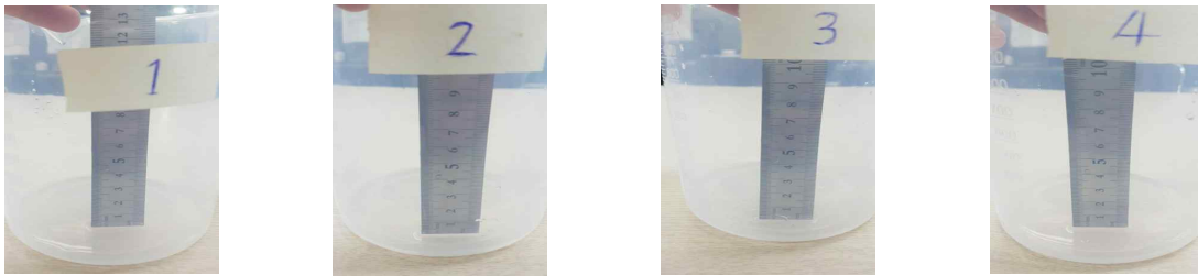
< 그림 3-39 > 강우강도 및 분포도 확인(25mm/hr)
