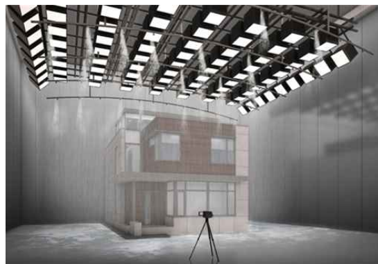
< 그림 1-4 > 다양한 환경 변화가 가능한 실험동 개요
