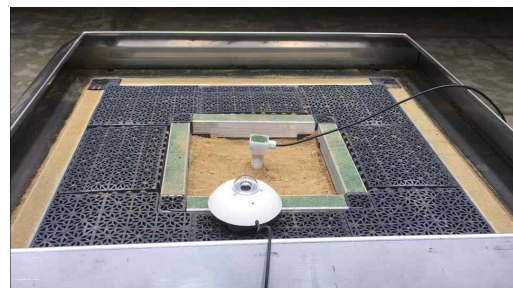
< 그림 3-73 > 어스그린코리아 가로수보호판, 808W/m 2
