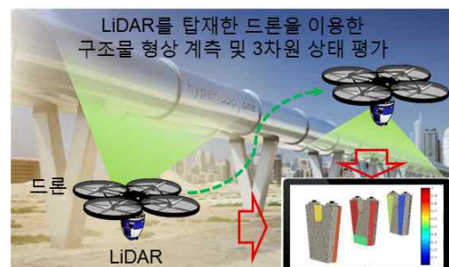
<LiDAR 탑재 드론을 이용한 구조물 형상 관리>
