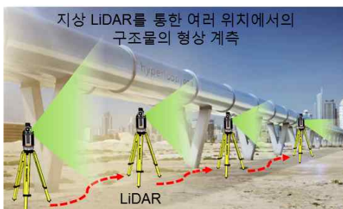
<기존 지상 LiDAR를 이용한 구조물 형상 관리>
