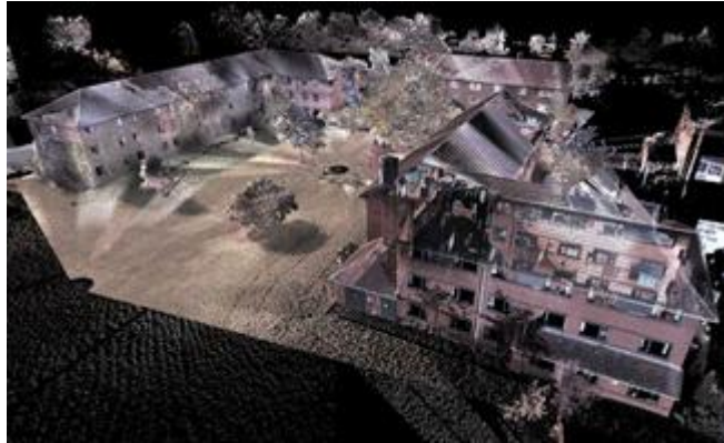
<3D 레이저 스캐닝을 통해 구축한 건물 3D 모델>
