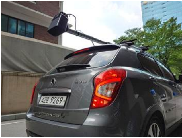
그림 2-3. 독일 Lufft사의 MARWIS-UMB 차량 이동형 광학식 노면 센서와 차량에 장착한 모습
