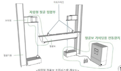
<자립형 철골보 조립시스템 개요도>
