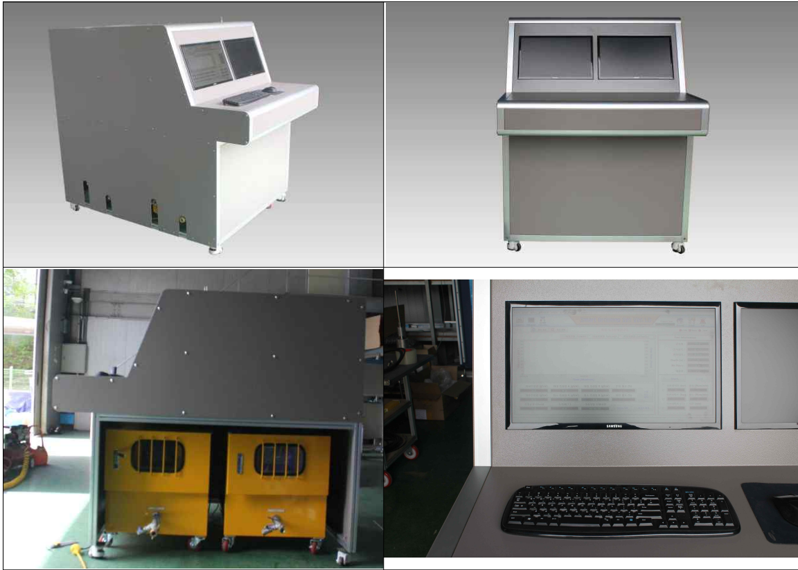
<그림 3.9> 그라우팅 지중 주입압력 통합제어장치 키호스트
