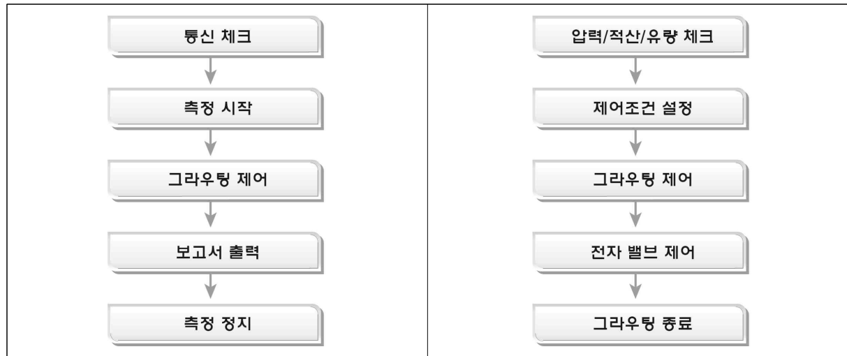
<그림 3.6> HSG GROUTING SYSTEM 제어 흐름도
