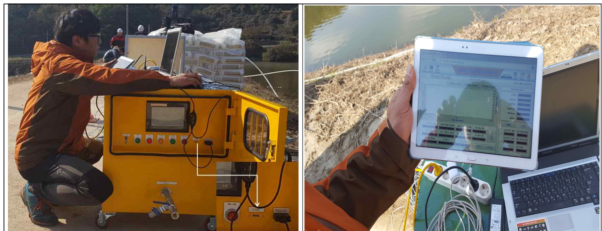
<그림 3.8> 현장data USB저장 및 태블릿을 이용한 그라우팅 실시간 확인
