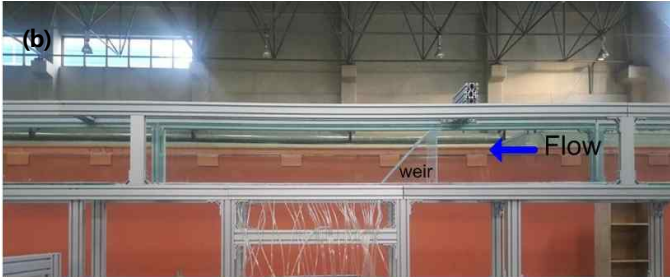
그림 17 수리실험 수로시설: (a) 전체수로전경, (b) Weir 보를 포함한 측면도, (c) 도수조건 실험전경
