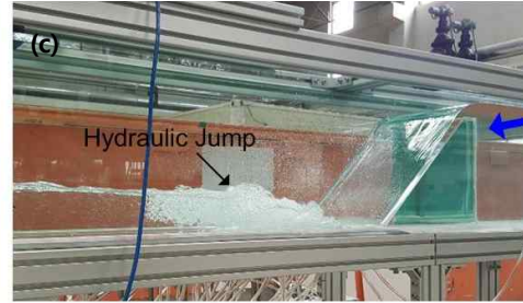
그림 17 수리실험 수로시설: (a) 전체수로전경, (b) Weir 보를 포함한 측면도, (c) 도수조건 실험전경
